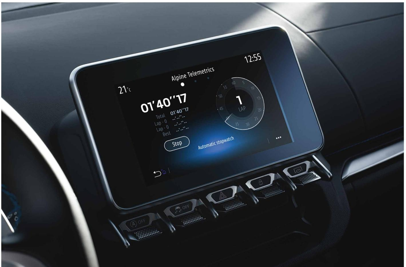
Alpine Telemetrics vous permet d'accéder en temps réel aux données techniques enregistrées par les différents capteurs embarqués de votre A110 (pression du turbo, température de la boîte de vitesses, couple, puissance, angle du volant, accéléromètre, etc.), et de les présenter sous forme de manomètres ou histogrammes intuitifs pour une visualisation immédiate. Le chronographe intégré mesurera et enregistrera vos performances lors des séances sur piste.
