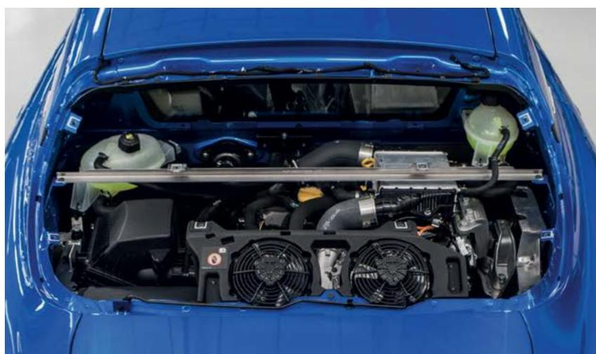
1,8litrový motor s přímým vstřikováním, vyladěný odborníky značky Alpine na pohonná ústrojí, přináší vzrušení a mimořádnou výkonnost. Nový motor o výkonu 300 k nabízí točivý moment 340 Nm, který je dostupný od 2 400 do 6 000 ot./min, zrychlení z 0 na 100 km/h za 3,9 sekundy a maximální rychlost až 285 km/h.
