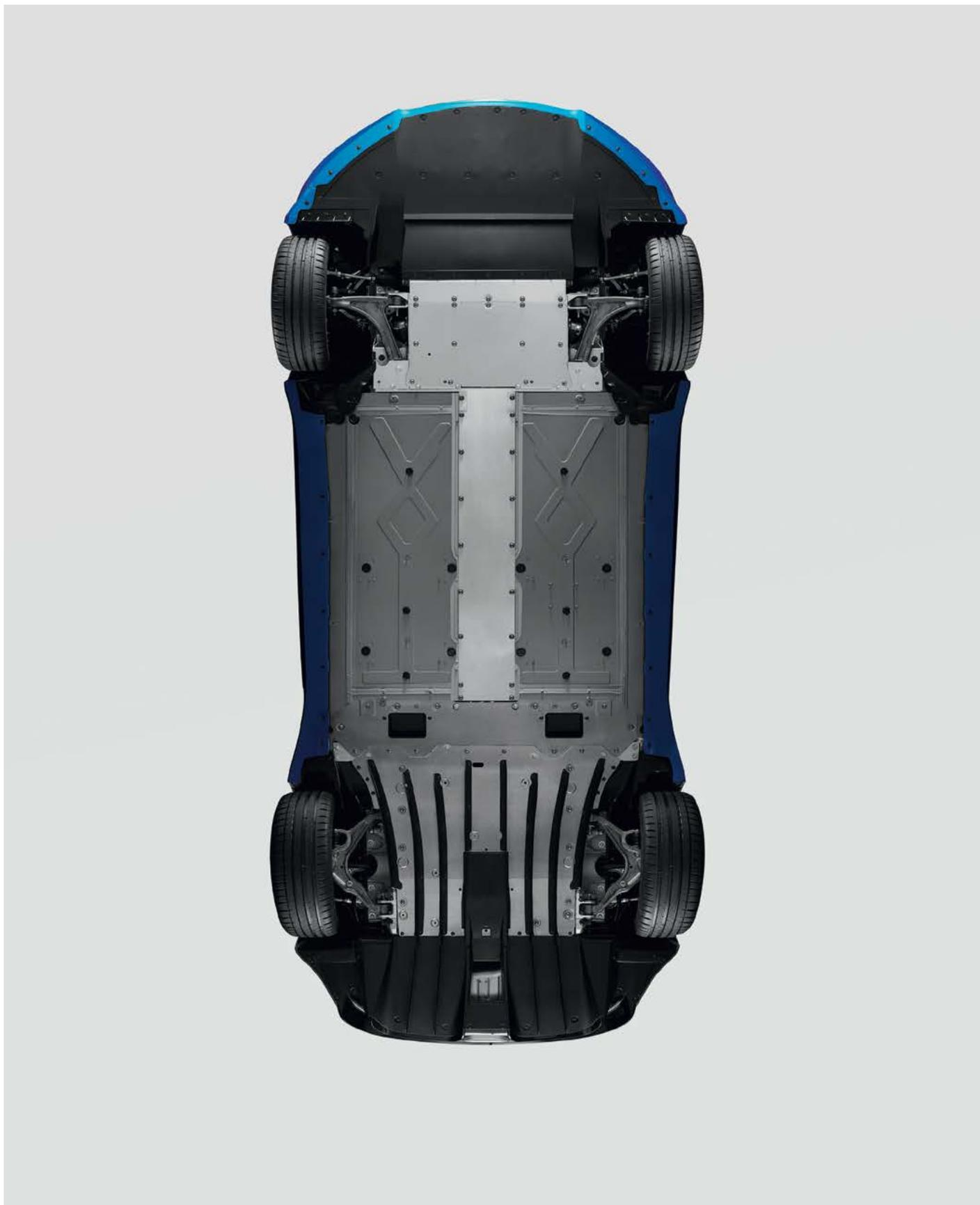
Vývojáři značky Alpine věnovali zvláštní pozornost aerodynamice modelu A110, když si vypůjčili technická řešení ze závodního světa. Zaslouhou toho má A110 spojitou rovnou podlahu, což je technika převzatá ze závodního světa na té nejvyšší úrovni. Díky zadnímu difuzoru umístěnému pod zadním nárazníkem nabízí A110 vynikající ovladatelnost zadní části.
