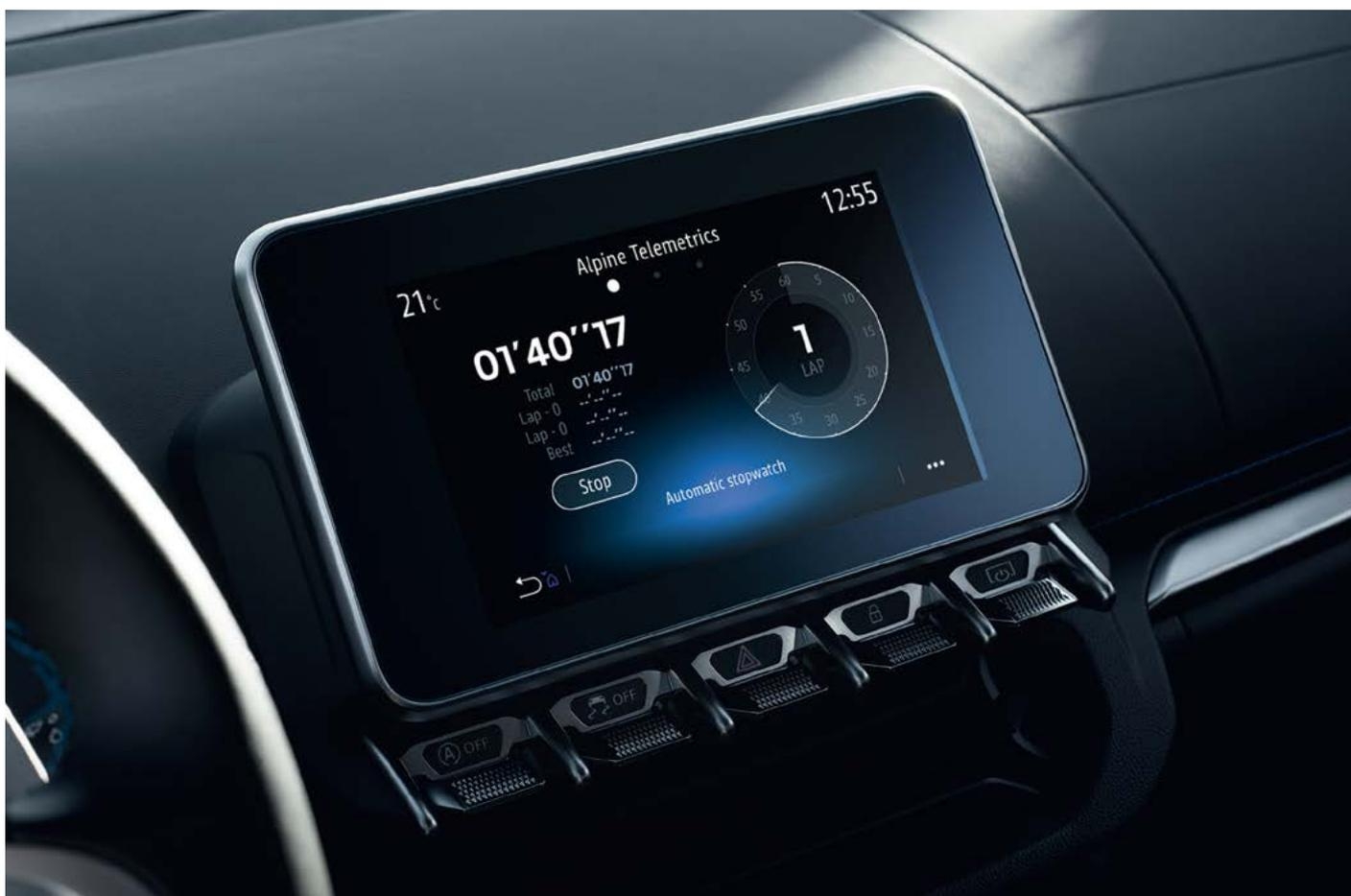
Alpine Telemetrics poskytuje v reálném čase přístup k technickým datům zaznamenaným senzory vozidla (tlaky, teploty, otáčky motoru, úhel natočení kol atd.) a prezentuje je prostřednictvím grafů. Integrované stopky navíc umožňují měřit průběžné časy na závodním okruhu a vaše výkony.
