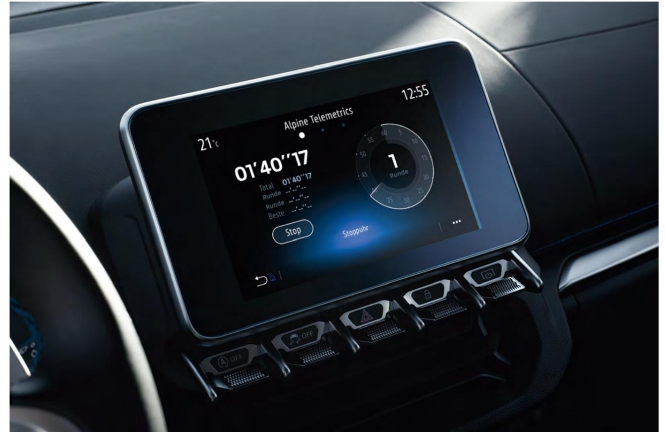
Alpine Telemetrics ermöglicht den Echtzeit-Zugriff auf die von den Fahrzeugsensoren aufgezeichneten technischen Daten (Ladedruck, Temperatur, Motordrehzahl, Lenkwinkel und Ähnliches) und stellt sie in digitalen Grafiken dar. Außerdem können Sie mit dem integrierten Chronografen Rundenzeiten und Leistung messen.
