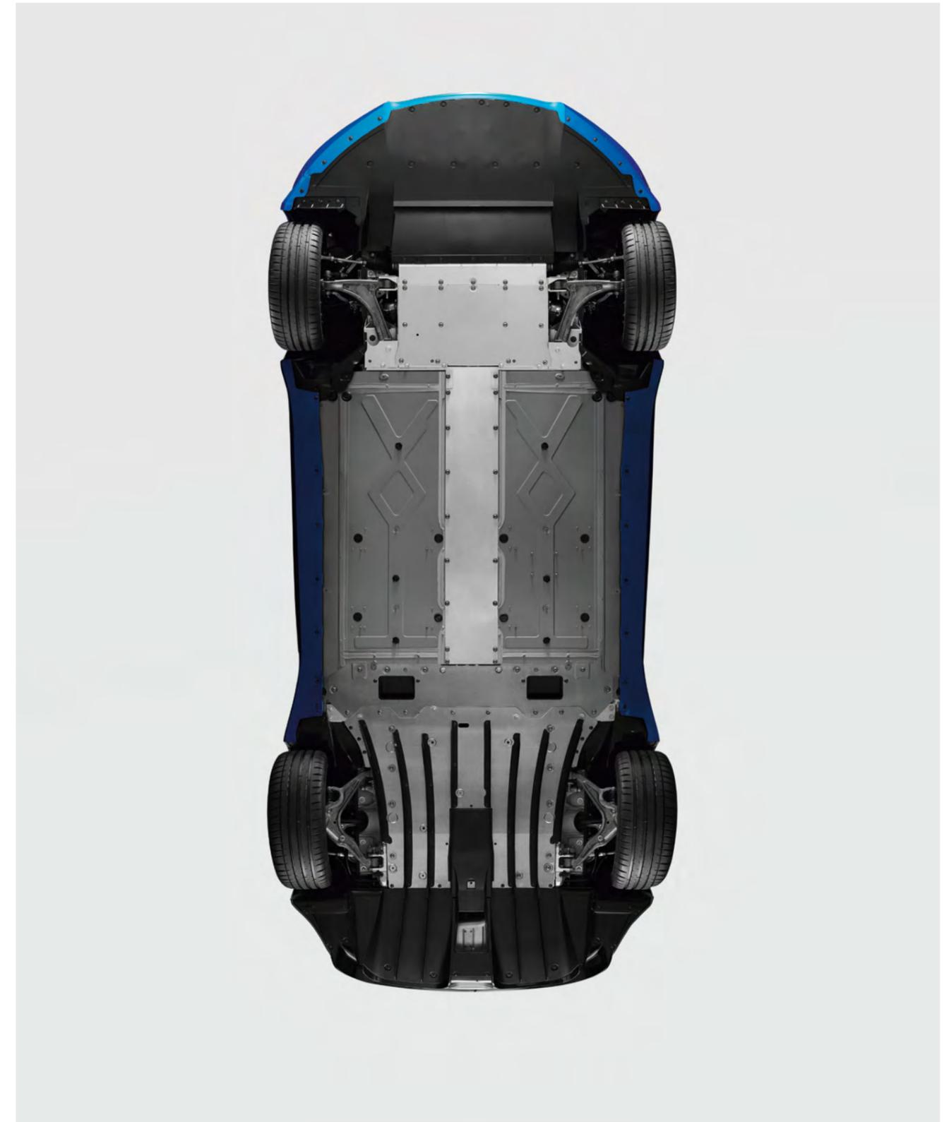
Die Ingenieure von Alpine haben der aerodynamischen Optimierung der Alpine A110 besondere Aufmerksamkeit gewidmet und dabei technische Lösungen aus dem Rennsport verwendet. So verfügt die A110 über einen besonders flachen Boden – ein Designprinzip, das aus der Welt des Hochleistungsrennsports übernommen wurde. Auch der Heckdiffusor unter dem hinteren Stoßfänger trägt zum hervorragenden Fahrverhalten der A110 bei.
