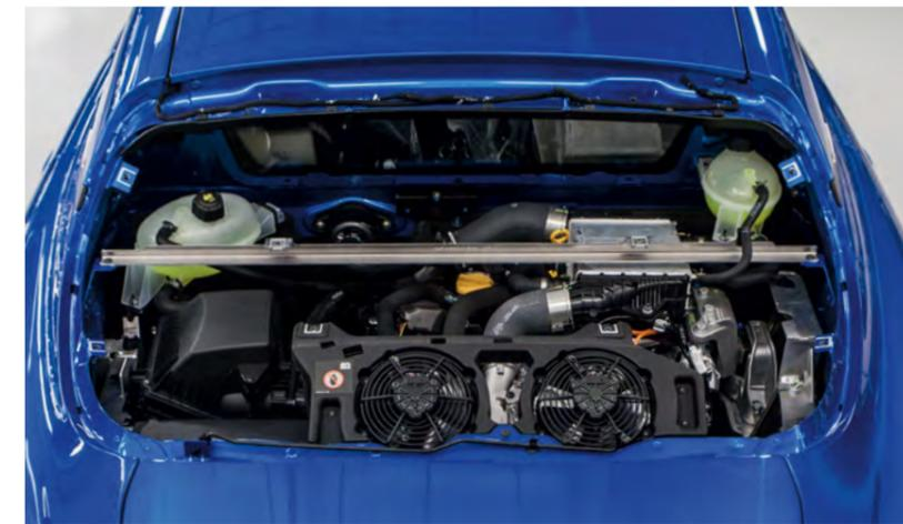
Der von den Alpine-Antriebsingenieuren abgestimmte 1,8-Liter-Direkteinspritzer sorgt für Adrenalin und starke Leistung. Der neue 300-PS-Motor bietet ein Drehmoment von 340 Nm, das in einem breiten Drehzahlenspektrum von 2400 bis 6000 U/min zur Verfügung steht. Er beschleunigt in 4,2 Sekunden von 0 auf 100 km/h und erreicht eine Höchstgeschwindigkeit von 275 km/h.
