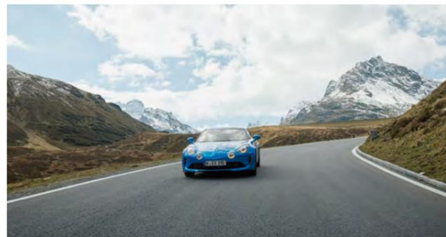
Die zentrierte Gewichtsverteilung ist entscheidend für ein verbessertes Fahrgefühl. 56% des Gewichts liegen auf der Hinterachse mit dem Motor im mittleren Heckbereich; 44% liegen auf der Vorderachse, hinter der sich der Kraftstofftank befindet. Das verleiht der A110 eine außergewöhnliche Ausgewogenheit und Agilität auf Gebirgsstraßen und im Flachland.
