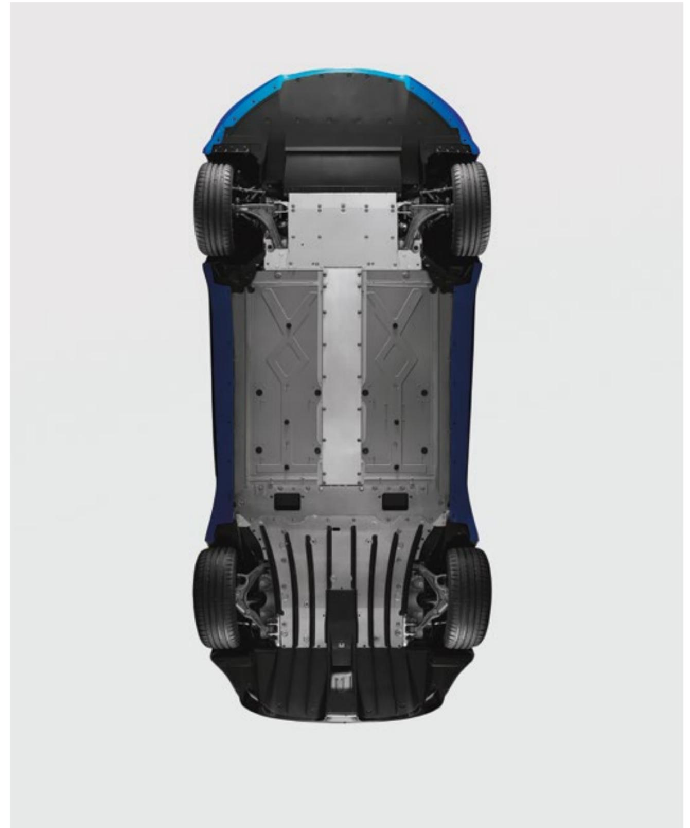
Die Ingenieure von Alpine haben auch der aerodynamischen Entwicklung der Alpine A110 besondere Aufmerksamkeit gewidmet und dabei technische Lösungen aus dem Rennsport verwendet. So verfügt die A110 über einen durchgängig flachen Boden – eine Technik, die aus der Welt des Hochleistungsrennsports übernommen wurde. Der Heckdiffusor unter dem hinteren Stossfänger sorgt für ein hervorragendes Fahrverhalten der A110.
