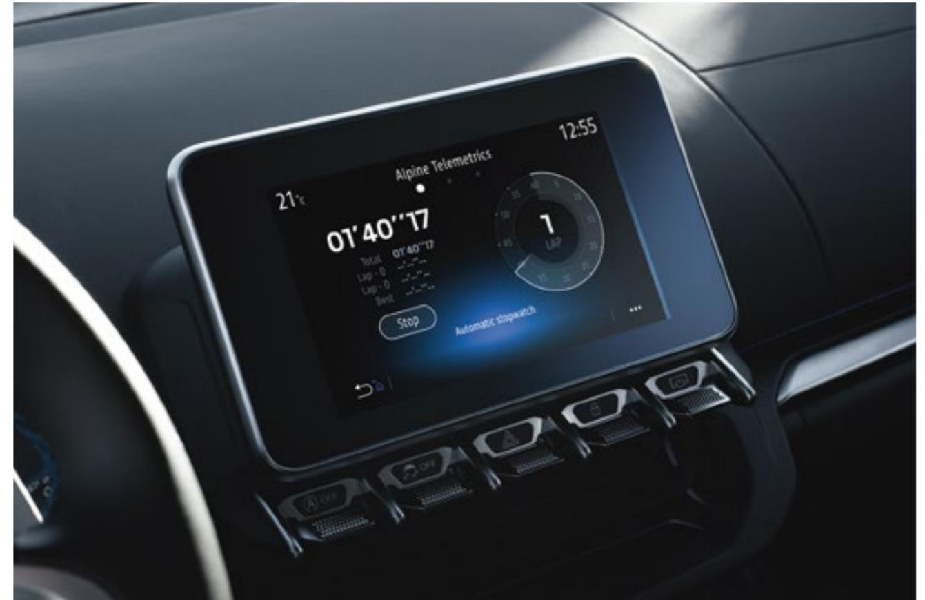
Alpine Telemetrics\* ermöglicht den Echtzeit-Zugriff auf die von den Fahrzeugsensoren aufgezeichneten technischen Daten (Druck, Temperatur, Motordrehzahl, Lenkradwinkel und Ähnliches) und stellt sie in digitalen Grafiken dar. Ausserdem können Sie mit dem integrierten Chronographen Rundenzeiten und Leistung messen.
