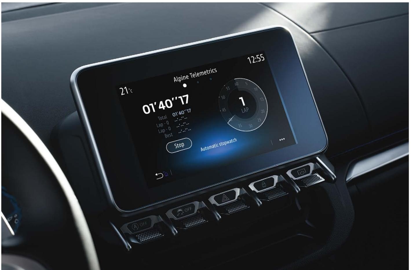
Alpine Telemetrics ti permette di accedere in tempo reale ai dati registrati dai sensori della tua A110 (pressione del turbo, temperatura dell'olio del cambio, coppia e potenza erogate, angolazione dello sterzo, accelerometro, ecc.). I dati vengono presentati in maniera intuitiva mediante manometri o istogrammi, per consentirti una lettura immediata. Il cronografo integrato misura e registra le tue prestazioni durante le sessioni in circuito.
