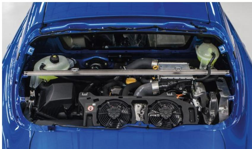
Desarrollado por los ingenieros mecánicos de Alpine, este motor de 1,8 l de inyección directa está diseñado para ofrecer un placer inmediato y un alto nivel de rendimiento. Dotado de 300 CV, entrega un par generoso disponible de 2.400 a 6.000 rpm/min propulsando al A110 de 0 a 100 km/h en sólo 4,2 segundos y hasta 275 km/h en circuito.
