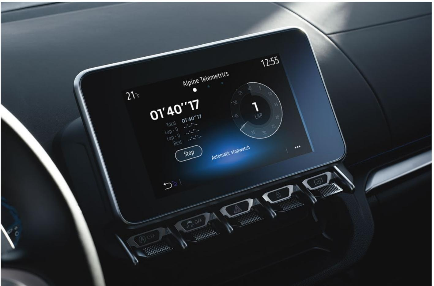
Alpine Telemetrics te permite acceder en tiempo real a los datos técnicos registrados por los diferentes sensores a bordo de tu A110 (presión del turbo, temperatura de la caja de cambios, par, potencia, ángulo del volante, acelerómetro, etc.) y presentarlos en forma de manómetros o histogramas intuitivos para una visualización inmediata. El cronógrafo integrado medirá y registrará tu rendimiento durante las sesiones en pista.
