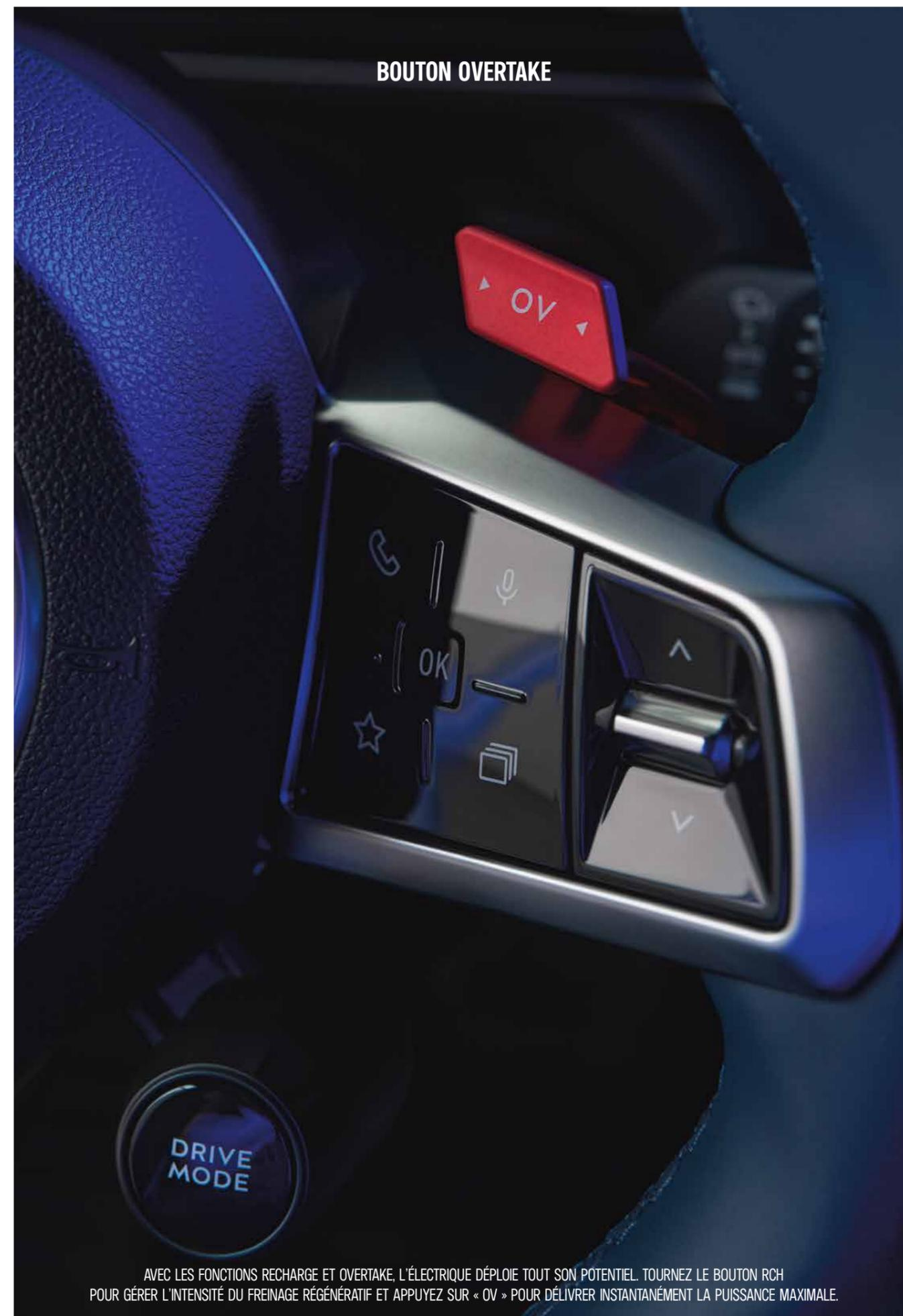
AVEC LES FONCTIONS RECHARGE ET OVERTAKE, L'ÉLECTRIQUE DÉPLOIE TOUT SON POTENTIEL. TOURNEZ LE BOUTON RCH POUR GÉRER L'INTENSITÉ DU FREINAGE RÉGÉNÉRATIF ET APPUYEZ SUR « OV » POUR DÉLIVRER INSTANTANÉMENT LA PUISSANCE MAXIMALE.
