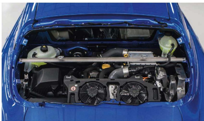
Il motore a iniezione diretta da 1,8 litri è stato progettato dagli ingegneri di Alpine per offrire il massimo del piacere di guida e delle prestazioni. I suoi 300 CV erogano una coppia generosa, disponibile da 2.400 a 6.000 giri/min, e portano la A110 R da 0 a 100 km/h in soli 3,9 secondi, con una velocità massima in pista di ben 285 km/h.
