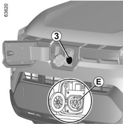
**Hinweis:** Entfernen Sie bei Schneefall vor dem Anschließen und Abziehen des Ladekabels den Schnee rund um die Steckdose des Fahrzeugs. Das Eindringen von Schnee in die Steckdose kann zur Blockierung des Ladekabels in der Steckdose führen.
