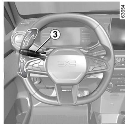
Bewegen Sie den Hebel **3** parallel zum Lenkrad in die Richtung, in die Sie es drehen möchten.
