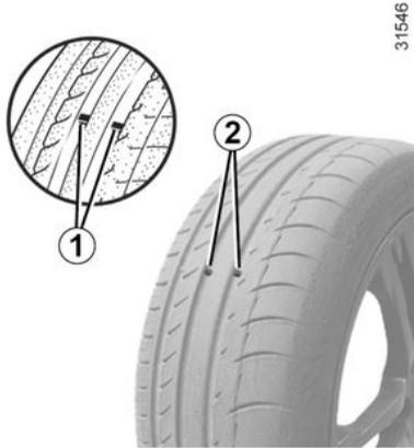
Die Reifen müssen in einwandfreiem Zustand sein und ihre Laufflächen müssen ein ausreichendes Profil aufweisen; die vom Hersteller zugelassenen Reifen sind mit einer Verschleißkontrolle **1** versehen. Es handelt sich dabei um
