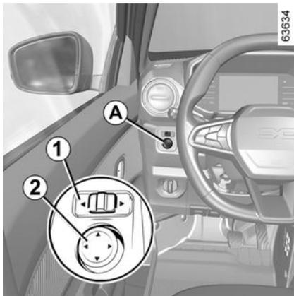
Die Außenspiegel können eingeclappt werden: Klappen Sie die Spiegel einfach mit der Hand gegen die Türscheibe.
