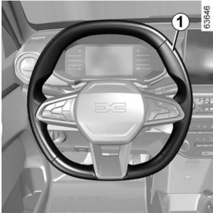
Die geschwindigkeitsabhängige Servolenkung umfasst ein elektronisches Steuergerät, das den Grad der Lenkunterstützung an die Fahrgeschwindigkeit anpasst.
