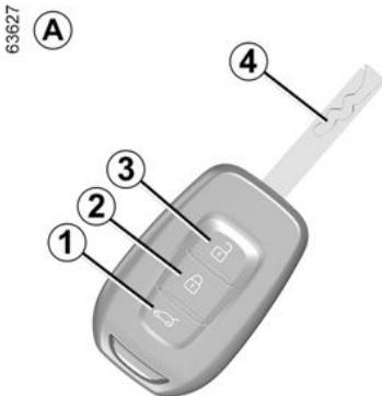
1. Verriegeln/Entriegeln (Heckklappe/ Gepäckraum)
