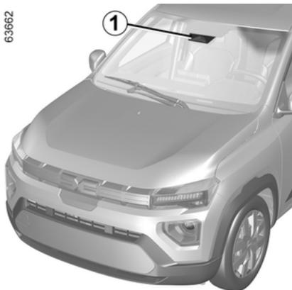
Anhand der Informationen der Kamera **1** löst die Funktion beim Überfahren einer durchgezogenen oder unterbrochenen Linie oder bei Annäherung an den Straßenrand (Spurtrenner, Leitplanke, Gehweg, Böschung usw.) eine Korrektur der Fahrzeuglenkung aus, ohne Aktivierung der Fahrrichtungsanzeiger.
