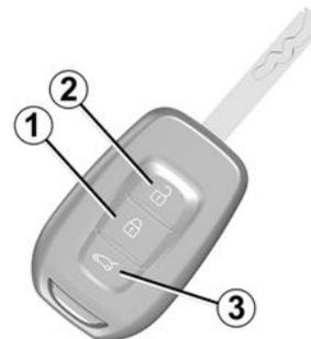
Durch Drücken von Taste **1** werden alle Türen und die Heckklappe verriegelt.
