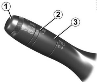
Falls im Fahrzeug vorhanden, wird das Tagfahrlicht beim Starten des Motors automatisch eingeschaltet, ohne dass es einer Betätigung des Hebels **1** bedarf, und erlischt beim Abstellen des Motors.
