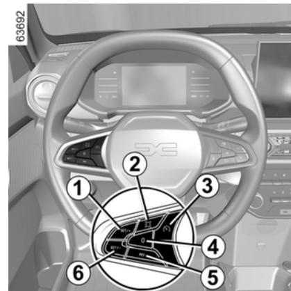
Drücken Sie bei konstanter Fahrt mit einer Fahrzeuggeschwindigkeit über etwa 30 km/h den Schalter **6 (SET/-)** oder den Schalter **1 (SET/+)**: Die Funktion wird aktiviert und die momentane Geschwindigkeit berücksichtigt.
