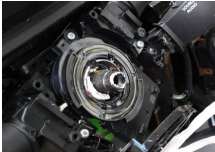
Lenksäule, hohl, teilbar hinter dem Lenkrad
