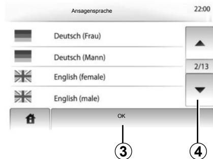
Lassen Sie durch Drücken auf 4 die Liste der Sprachen durchlaufen. Drücken Sie auf die gewünschte Sprache und anschließend auf 3, um zu bestätigen.
