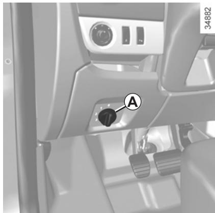
La commande **A** permet de corriger la hauteur des faisceaux en fonction de la charge.
