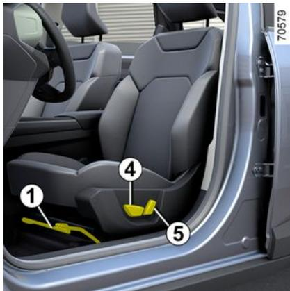
Actionnez le contacteur **4** vers le haut ou vers le bas, ou suivant véhicule, manœuvrez la poignée **2** autant de fois que nécessaire vers le haut ou vers le bas jusqu'à la position désirée.
