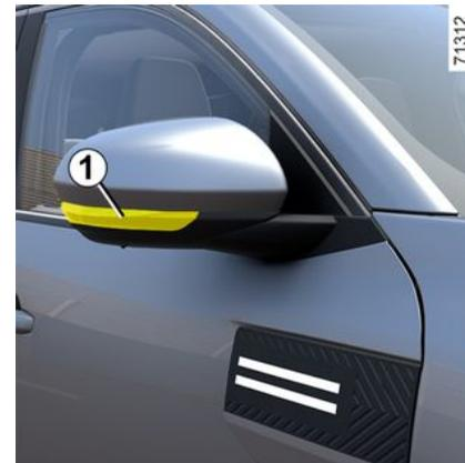
Du fait de la nécessité de démonter le porte-miroir du rétroviseur, **nous vous conseillons de faire remplacer la lampe par un Représentant de la marque.**
