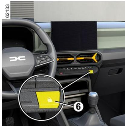
Le contacteur **6** commande simultanément les portes, le coffre et la trappe à carburant.
