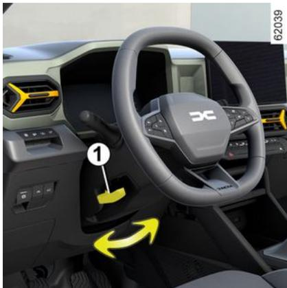
Suivant véhicule, la position du volant est réglable en hauteur et en profondeur.
