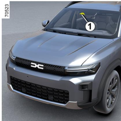
À partir des informations provenant de la caméra **1**, cette fonction avertit le conducteur de l'intervalle de temps qui le sépare du véhicule qui le précède afin de respecter les distances de sécurité entre les deux véhicules.
