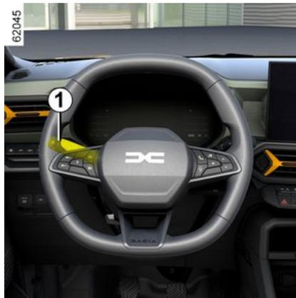
Lorsque le véhicule en est équipé, les feux de jour et les feux de position arrière s'allument automatiquement sans action sur la manette **1** au démarrage du moteur et s'éteignent à l'arrêt du moteur.
