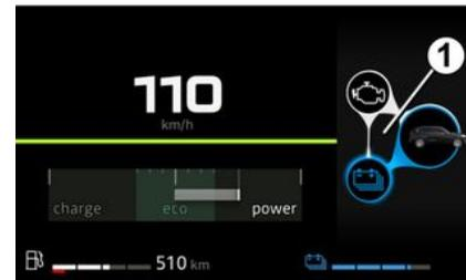
Selon le mode de conduite sélectionné, l'indicateur **1** représente les flux d'énergie entre :
