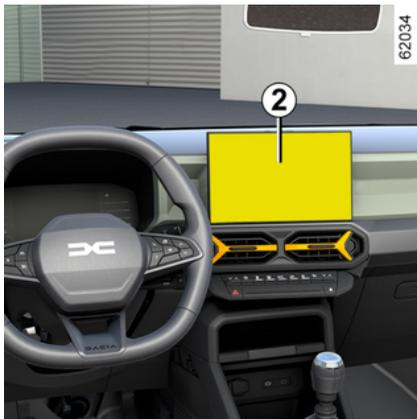
Depuis l'écran multimédia 2, lorsque la marche arrière est engagée, appuyez sur le bouton « Réglages » afin d'ajouter ou de supprimer les gabarits et régler les paramètres de l'image de la caméra (luminosité, contraste...).
