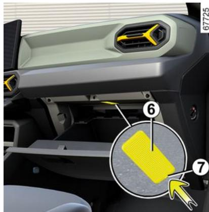
Déclipsez l'éclaireur 6 à l'aide d'un outil type tournevis plat en pressant sur la languette 7 pour basculer l'éclaireur vers l'intérieur de la boîte à gants.
