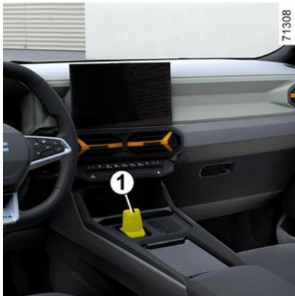
Basculez le levier de sélection **1** d'un cran ou de deux crans vers l'avant ou vers l'arrière pour engager la position désirée (**R**, **N**, **D** ou **B**) puis relâchez le levier, il revient dans sa position stable.
