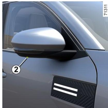
Les caméras **2**, implantées dans les rétroviseurs extérieur, transmettent les vues latérales sur l'écran **4**.
