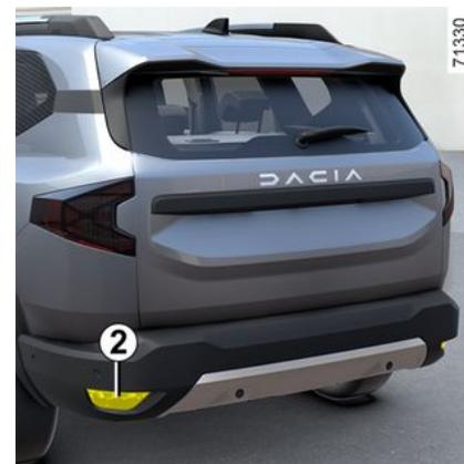
Accédez au porte-lampe situé sous le bouclier arrière, puis dévissez-le en tournant vers le centre du véhicule et sortez la lampe.
