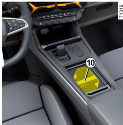
Le range-gobelet est équipé de crochets de retenue pour gobelet **10**.
