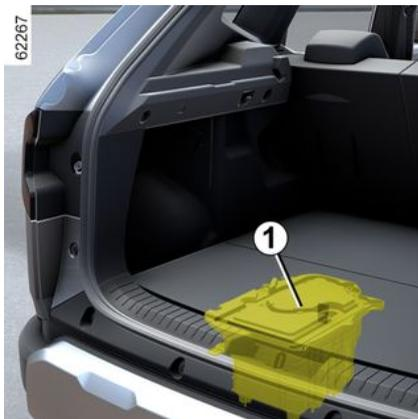
La batterie « 12 volts » **1** est située à l'arrière du véhicule Hybrid : elle fournit l'énergie nécessaire à l'ouverture/fermeture du véhicule et au fonctionnement des équipements.
