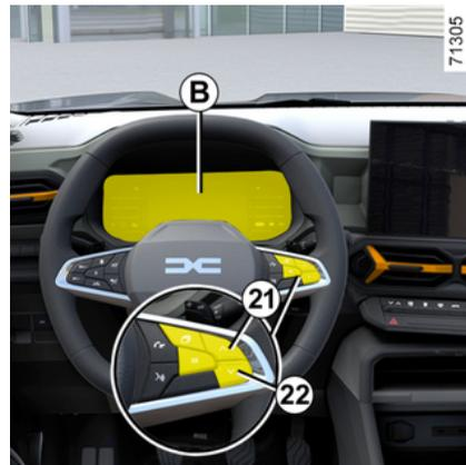
Suivant véhicule, naviguez à l'aide de la commande 21 ou 22 pour sélec-
