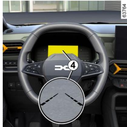
Fonction activée, le témoin
