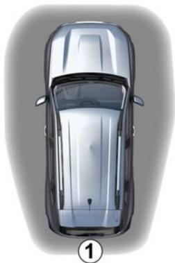
Le mode « mains libres » permet le verrouillage/déverrouillage sans action sur les boutons de la carte lorsque celle-ci est présente dans la zone d'accès **1**.
