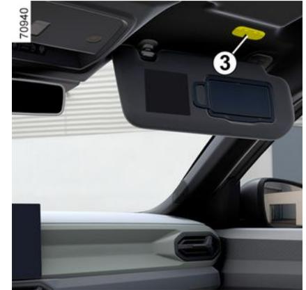
Déclipsez l'éclaireur **3** à l'aide d'un outil type tournevis plat en pressant sur la languette côté gauche de l'éclaireur. Dégagez la lampe concernée.
