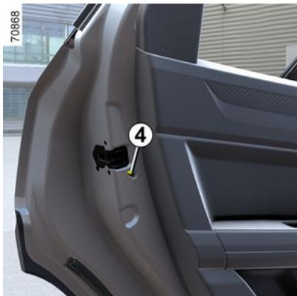
Pour rendre impossible l'ouverture des portes arrière de l'intérieur, déplacez le levier **4** de chaque porte et vérifiez de l'intérieur que les portes sont bien condamnées.
