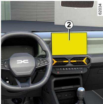
Suivant véhicule, contact mis, via l'écran multimédia **2** vous pouvez désactiver le système.
