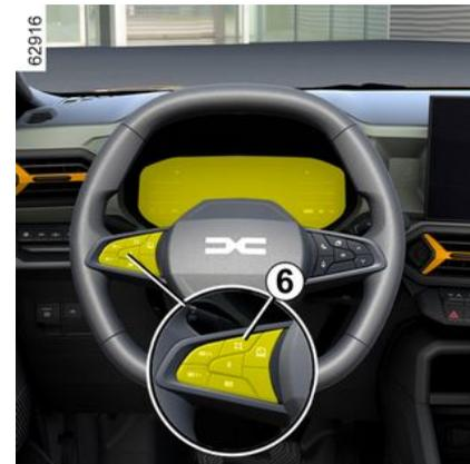
Pour adapter la consigne du limiteur de vitesse, du régulateur de vitesse ou, suivant véhicule, du régulateur de vitesse adaptatif Stop and Go aux limitations de vitesse détectées, appuyez sur le contacteur **6**.
