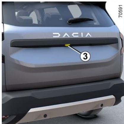
La caméra arrière activée automatiquement ou manuellement, la vue de la caméra s'affiche sur l'écran 4.
