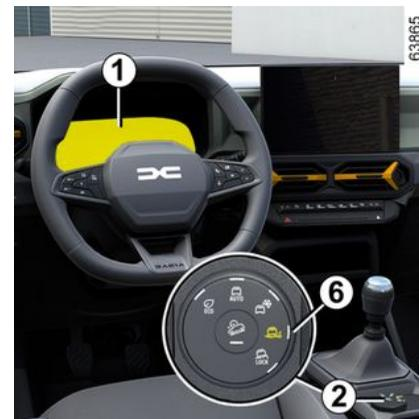
Pour activer ce mode, tournez le sélecteur **2** en position « **MUD-SAND** » **6** : le voyant intégré au sélecteur s'allume et le témoin « **MUD-SAND** » s'affiche au tableau de bord **1** pour confirmer l'activation.
