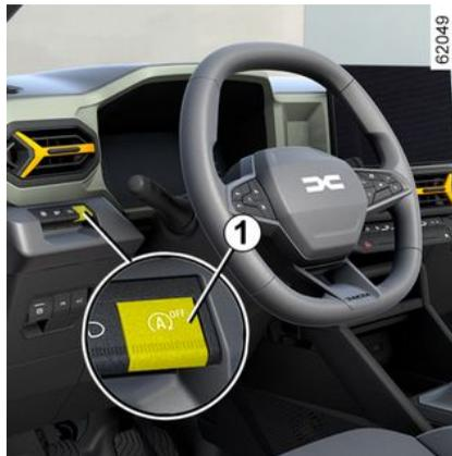
Appuyez sur le contacteur **1** pour désactiver la fonction. Le message « Stop & Start désactivé » apparaît au tableau de bord et le témoin du contacteur **1** s'allume.
