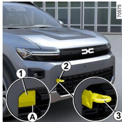
Pour accéder au point de remorquage **2**, déclipsez le cache avant **1** en passant un outil type tournevis plat sous le cache dans l'encoche **A**.
