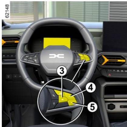
Un appui sur l'un des contacteurs **3** « OK », **4** ou **5** arrête l'affichage du message et des témoins.
