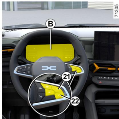
Suivant véhicule, naviguez à l'aide de la commande **21** ou **22** pour sélectionner différents widgets sur le tableau de bord :
