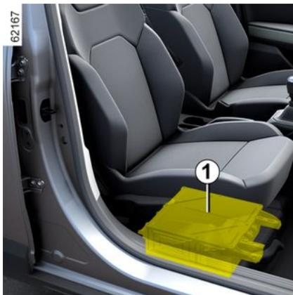
Suivant véhicule, une batterie secondaire **1** est située sous le siège passager avant ou, suivant véhicule, sous le siège conducteur dans un compartiment spécifique : elle fournit l'énergie nécessaire au fonctionnement de certains équipements.
