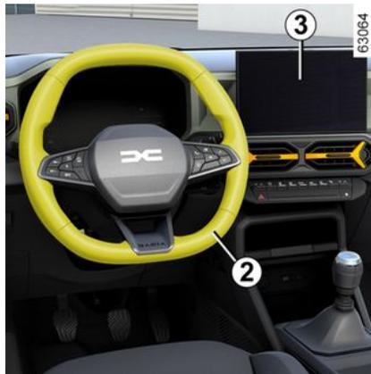
Cette fonction assure le chauffage du volant de direction **2**.
