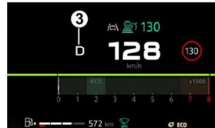
L'afficheur **3** au tableau de bord vous informe de la position engagée du levier de sélection **1**.
