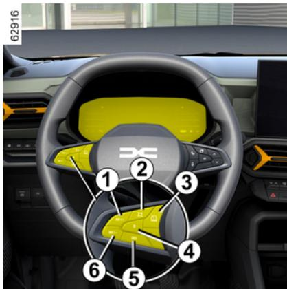
À vitesse stabilisée (supérieure à 30 km/h environ), pressez le contacteur **6** (**SET/-**) ou le contacteur **1** (**SET/+**) : la fonction est activée et la vitesse courante est prise en compte.
