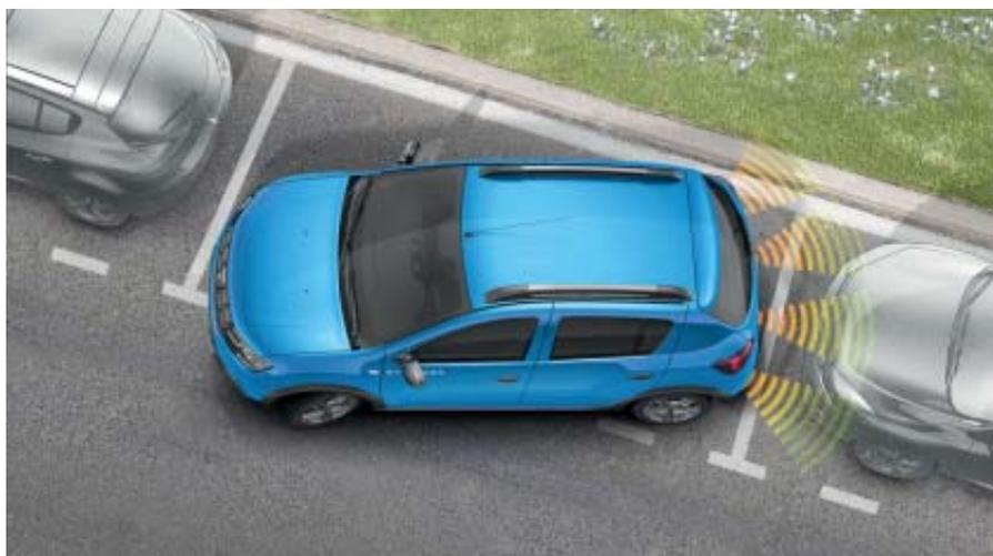
**Aide au parking arrière\*** : Une séquence de « bips » avertit le conducteur de la présence d'obstacles situés à l'arrière de son véhicule. Et pour encore plus de confort et de sécurité, vous pouvez choisir d'y coupler une caméra de recul.
