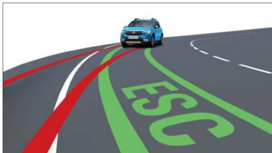
**ESC** : Le système permet de stabiliser la trajectoire du véhicule en cas de perte d'adhérence dans les virages en agissant sur la répartition du freinage et le régime du moteur.
