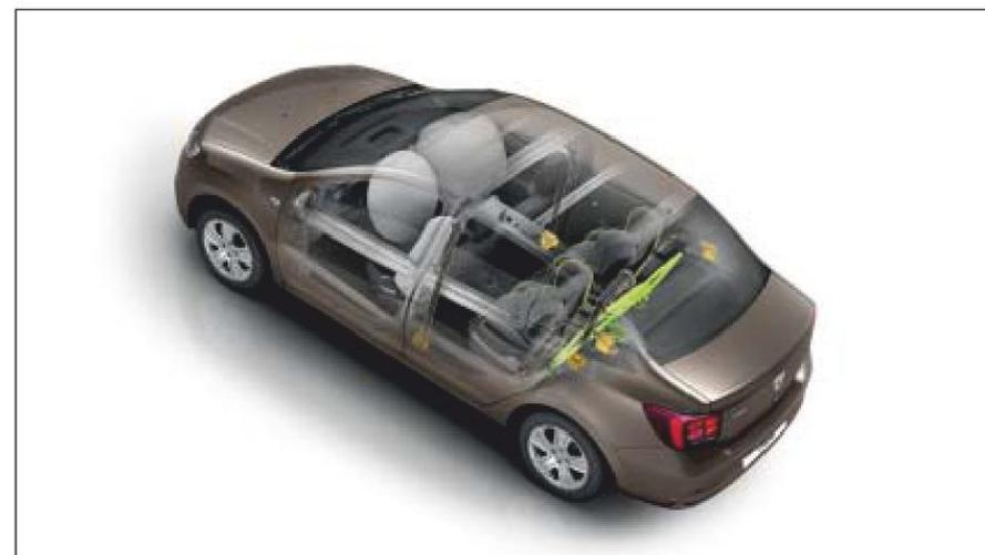
**Protection :** Structure renforcée, airbags frontaux et latéraux avant, fixation Isofix pour siège enfant située au niveau des places latérales arrière.
