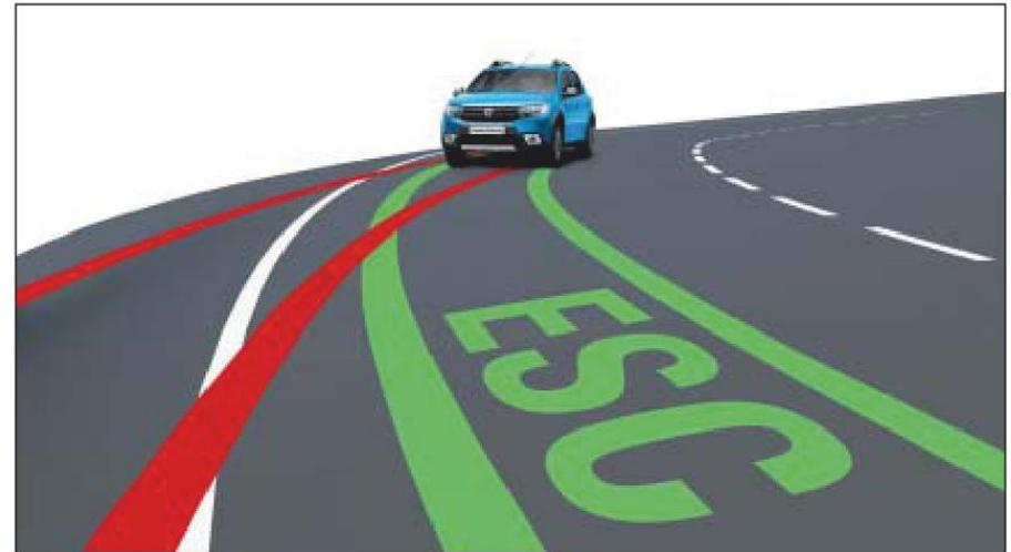
**ESC :** Le système permet de stabiliser la trajectoire du véhicule en cas de perte d'adhérence dans les virages en agissant sur la répartition du freinage et le régime du moteur.
