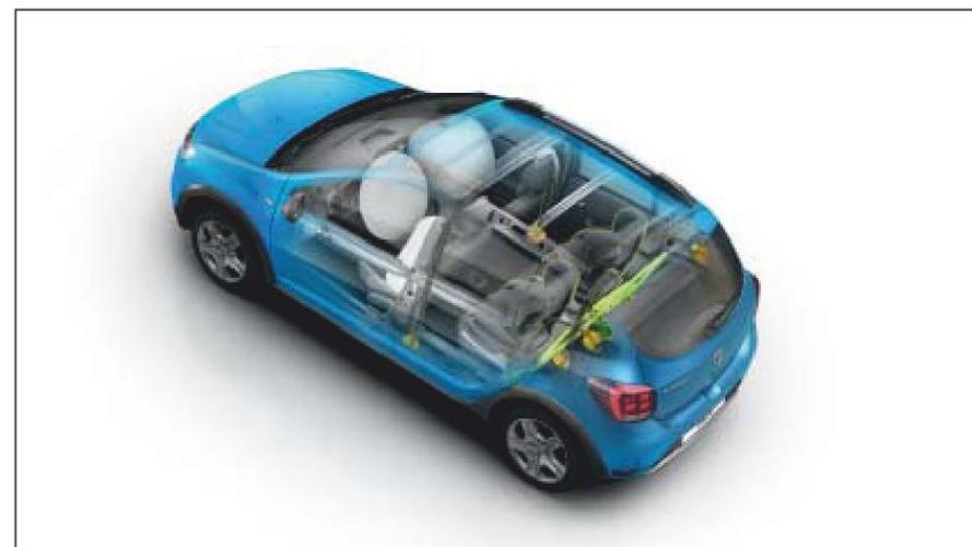
**Protection :** Structure renforcée, airbags frontaux et latéraux avant, fixation Isofix pour siège enfant située au niveau des places latérales arrière.
