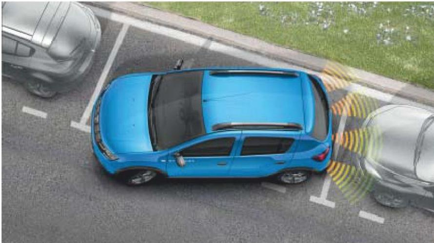
**Aide au stationnement arrière :** Une séquence de « bips » avertit le conducteur de la présence d'obstacles situés à l'arrière de son véhicule. Et pour encore plus de confort et de sécurité, vous pouvez choisir d'y coupler une caméra de recul.
