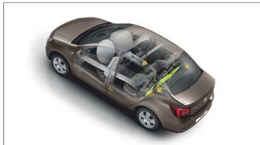
Bescherming: versterkte structuur, frontale en zijdelingse airbags vooraan, Isofix-bevestiging voor een kinderzitje op de zijdelingse plaatsen achteraan.
