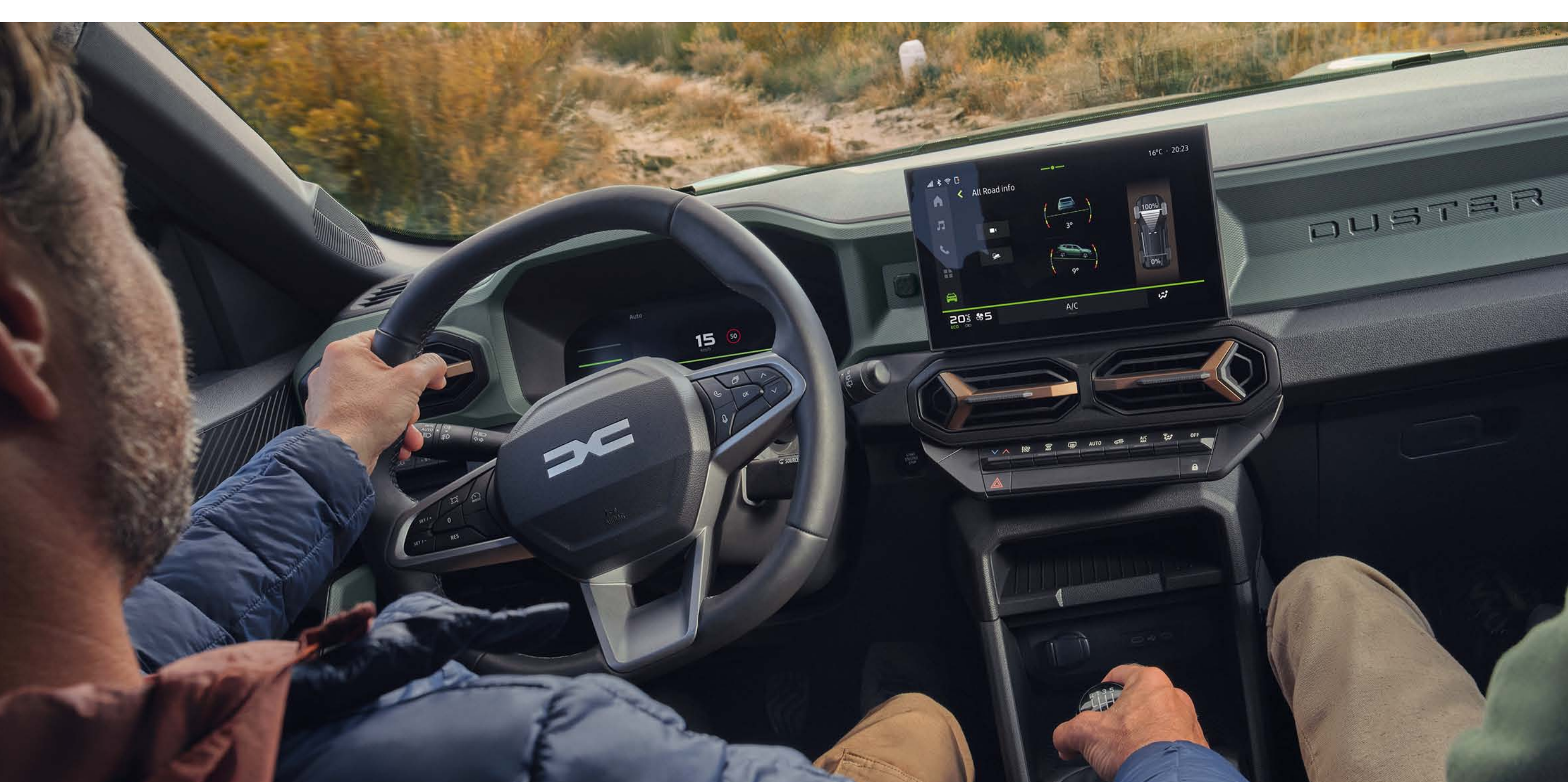
Écran tactile avec informations 4x4 : angles de pente et puissance par essieu
