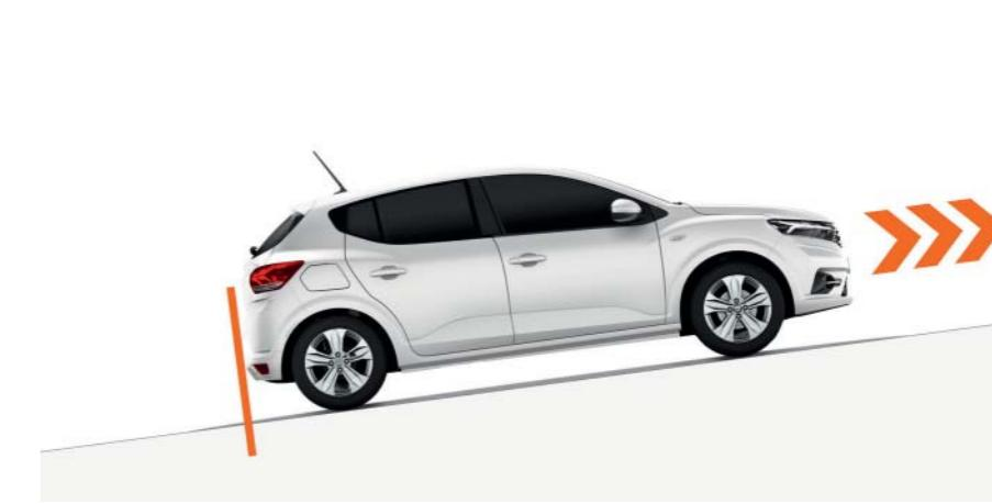
**Berganfahrhilfe.** Das Anfahren an einer Steigung wird mit diesem System ganz leicht. Es verhindert zuverlässig ein Zurückrollen, wenn Sie den Fuss von der Bremse nehmen.
