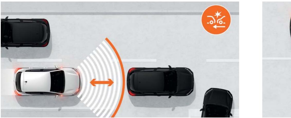
**Automatische Notfallbremsfunktion.** Auch wenn Sie immer aufmerksam und konzentriert fahren – manche Situationen lassen sich kaum vorhersehen. Dann hilft die automatische Notfallbremsfunktion. Wenn das System die Gefahr einer Kollision erkennt und Sie nicht schnell genug reagieren, baut es die maximale Bremskraft auf und bringt Ihren Neuen Dacia Sandero sicher zum Halten.
