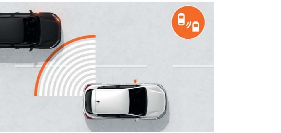
**Toter-Winkel-Assistent.** Bei Spurwechseln oder beim Abbiegen warnt Sie der Toten-Winkel-Assistent des Neuen Dacia Sandero vor einem Zusammenstoss, wenn seine Sensoren ein Fahrzeug registrieren, das neben oder seitlich hinter Ihnen fährt.
