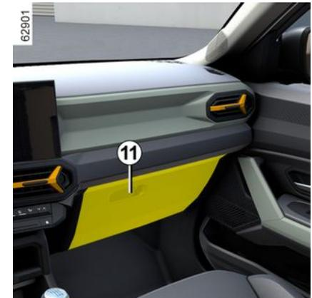
Ziehen Sie zum Öffnen am Griff **11**. Dieses Handschuhfach kann Dokumente im DIN-A4-Format aufnehmen. Die Innenseite der Handschuhfachklappe enthält ein Aufnahmefach für Stifte, Karten usw.
