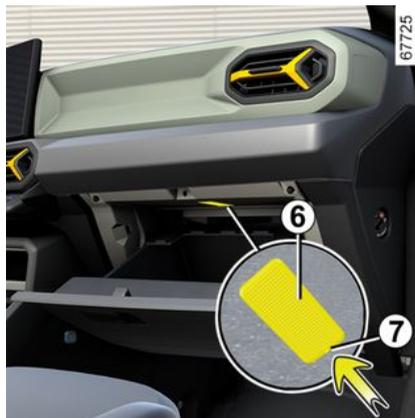
Die Leuchte **6** (mithilfe eines Schlitzschraubendrehers o. Ä.) lösen, indem Sie auf die Zunge **7** drücken, um die Leuchte in Richtung des Handschuhfachs zu bewegen
