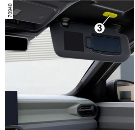
Rasten Sie die Leuchte **3** (mithilfe eines Flachklingen-Schraubendrehers o. Ä.) aus und drücken Sie dabei auf die Federzunge an der linken Seite.
