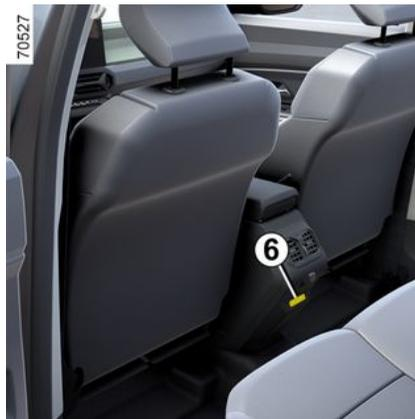
Die Multimedia-Anschlussbuchsen USB-C **2** und **6** können verwendet werden, um Zubehör mit einer maximalen Leistung von 12 Watt (5 Volt) pro Anschlussbuchse zu laden.
