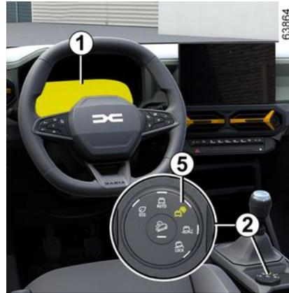
Um diesen Modus zu aktivieren, drehen Sie den Wahlschalter **2** auf die Position „**SNOW**“ **5**: Das Licht im Wahlschalter leuchtet auf.
