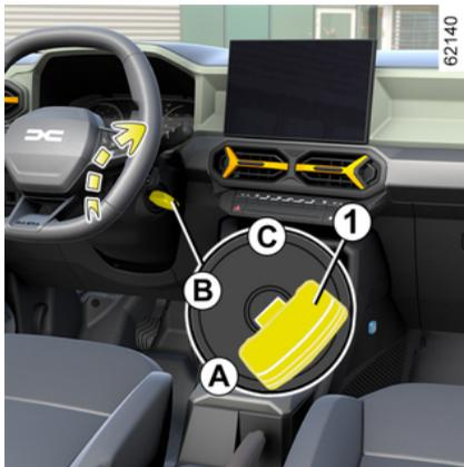
Zum Verriegeln ziehen Sie den Schlüssel **1** ab und drehen das Lenkrad, bis das Lenkradschloss einrastet.
