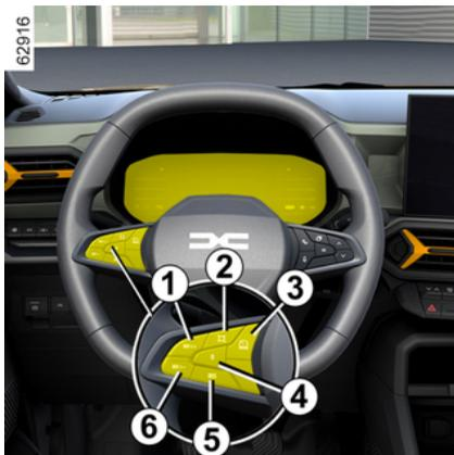
Drücken Sie bei konstanter Fahrt mit einer Fahrzeuggeschwindigkeit über etwa 30km/h den Schalter **6** ( SET/- ) oder den Schalter **1** ( SET/+ ): Die Funktion wird aktiviert und die aktuelle Geschwindigkeit berücksichtigt.
