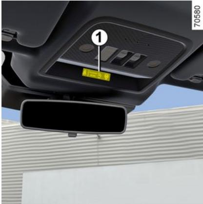
Die Kontrolllampe **1** leuchtet auf, wenn die Zündung eingeschaltet wird. Sie erlischt nach wenigen Sekunden wieder.
