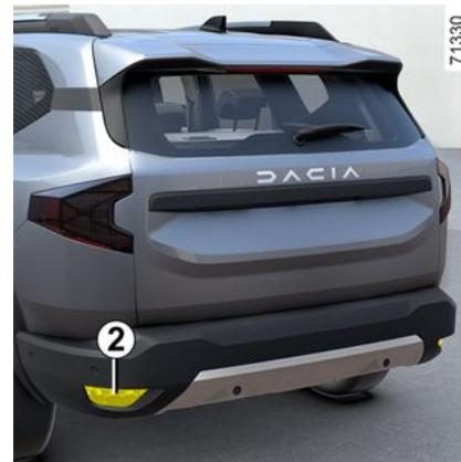
Greifen Sie auf die Lampenfassung unter der hinteren Stoßstange zu, schrauben Sie sie ab, indem Sie sie in Richtung Fahrzeugmitte drehen, und nehmen Sie die Lampe heraus.
