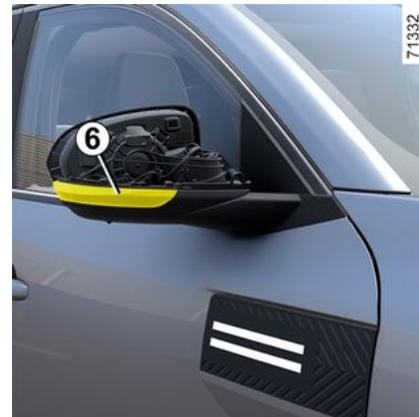
– die Abdeckung **6** des Blinkers **1** lösen, um an die Lampe zu gelangen;
