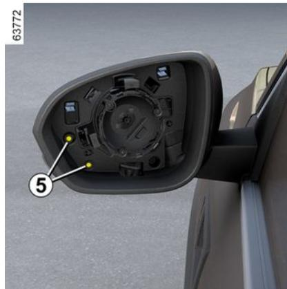
– die Schrauben **5** mit einem Schraubendreher lösen;
