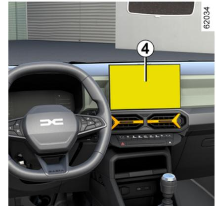
Der Automatikmodus wird aktiviert, wenn der Rückwärtsgang eingelegt und auf dem Bildschirm 4 die Rückfahrkameraansicht angezeigt wird. Bei einem schneller Wechsel vom Rückwärtsgang in einen Vorwärtsgang zeigt der Bildschirm 4 das von der Frontkamera übertragene Bild an.
