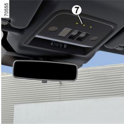
Verwenden Sie das Mikrofon **7** und die Bedieneinheit am Lenkrad **4**.
