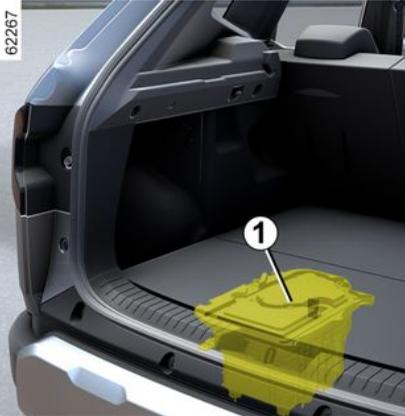
Die 12-V-Batterie **1** befindet sich hinten im Fahrzeug Hybrid: Diese liefert die Energie, die zum Entriegeln/Verriegeln des Fahrzeugs und zum Betrieb der elektrischen Verbraucher erforderlich ist.
