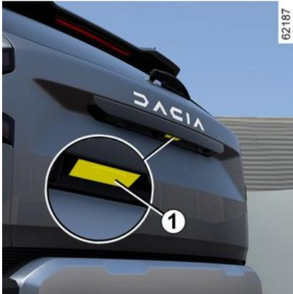
Drücken Sie auf Knopf **1** und öffnen Sie die Heckklappe.
