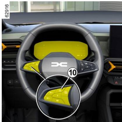
Drücken Sie den Schalter **10**, um die erkannte Geschwindigkeitsbegrenzung für die Geschwindigkeitsbegrenzungsbzw. -regelungsfunktion oder für den adaptiven Tempomaten Stop and Go zu übernehmen.
