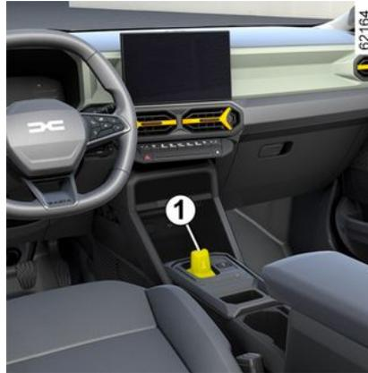
Schalten Sie den Wahlhebel **1** eine oder zwei Stufen nach vorne oder nach hinten, um die gewünschte Position (**R**, **N**, **D** oder **B**) zu wählen und lassen Sie den Wahlhebel dann los. Dieser kehrt dann in seine stabile Position zurück.
