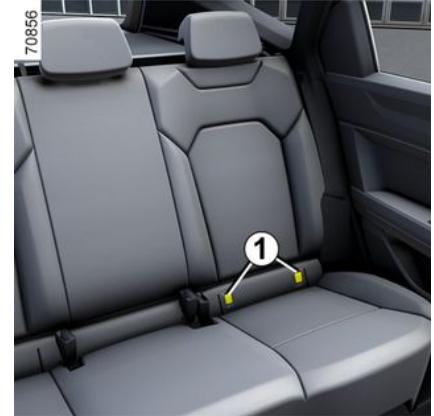
Die zwei Ringe befinden sich hinter Reißverschlüssen **1** zwischen Rückenlehne und Sitzfläche und sind
