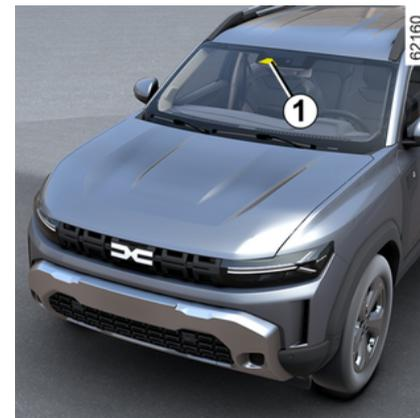
Anhand der Informationen der Kamera **1** löst die Funktion beim Überfahren einer durchgezogenen oder unterbrochenen Linie oder bei Annäherung an den Straßenrand (Spurtrenner, Leitplanke, Gehweg, Böschung usw.) eine Korrektur der Fahrzeuglenkung aus,
