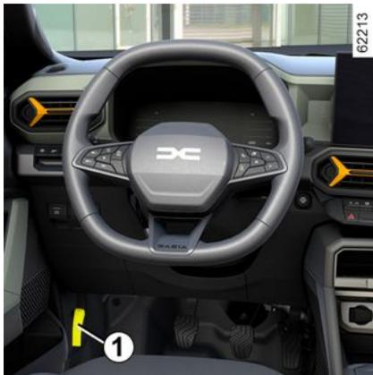
Je nach Fahrzeug, ziehen Sie den Hebel **1** zum Öffnen.
