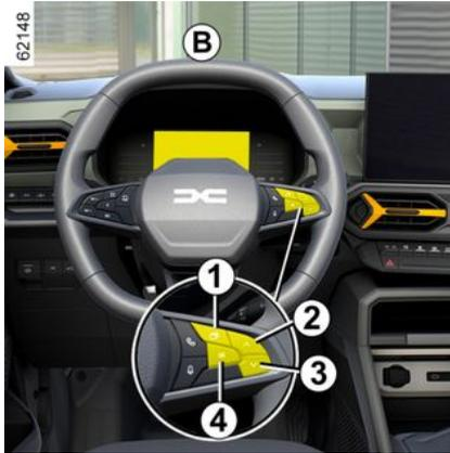
Je nach Fahrzeug können folgende Funktionen in Zone **6** angezeigt werden. Wählen Sie die Funktionen durch wiederholtes Drücken des Schalters **2** oder **3** aus:
