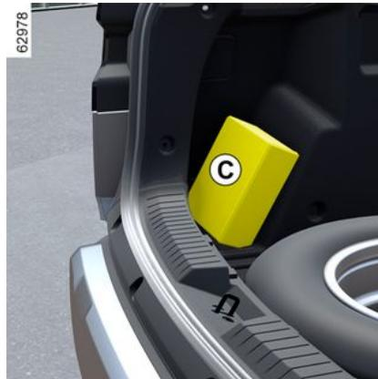
Verwenden Sie je nach Fahrzeug das im Gepäckraum befindliche Reifenfüllset **C**.
