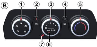
Mit dem Bedienhebel **7** können Sie den Umluftbetrieb/die Luftumwälzung ein- und ausschalten.
