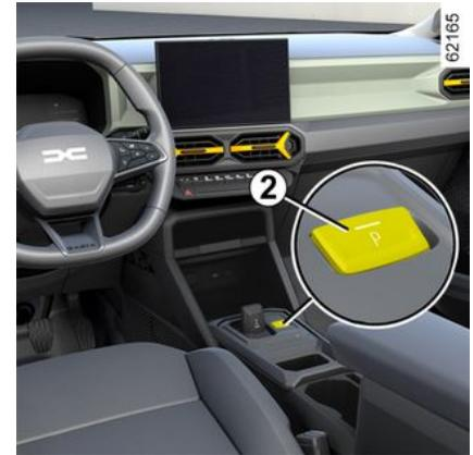
Drücken Sie bei stehendem Fahrzeug und laufendem Motor oder eingeschalteter Zündung die Taste **2**, um die Position **P** zu wählen. Die Kontrollleuchte in der Taste **2** leuchtet orange, sobald die Park-Position **P** des Automatikgetriebes eingelegt ist.
