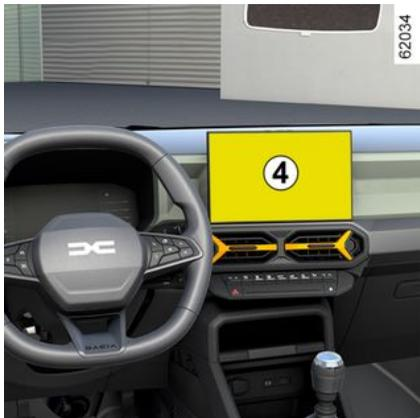
Die Kameras übertragen vier separate Ansichten auf den Bildschirm 4 und ermöglichen so die Sicht auf die Umgebung des Fahrzeugs.
