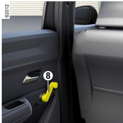
Betätigen Sie die Handkurbel **8** zum Öffnen oder Schließen des Fensters bis zur gewünschten Höhe.
