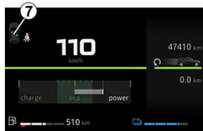
Wenn bei geschlossenen Türen die Zündung eingeschaltet wird, erscheint etwa 60 Sekunden lang die Grafik **7** an der Instrumententafel. Diese infor-
