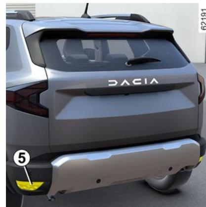
Schaffen Sie Zugriff auf den Lampenträger unter dem hinteren Stoßfänger, schrauben Sie ihn durch Drehen in Richtung Fahrzeugmitte los, und entfernen Sie die Lampe.
