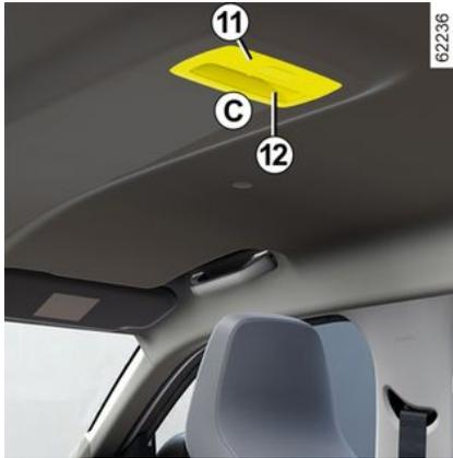
– Lösen Sie die Streuscheibe **12** mit einem Flachklingen-Schraubendreher an Bereich **C**.
