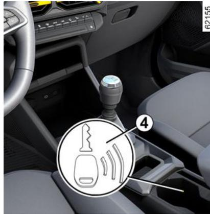
Treten Sie das Brems- oder Kuppelungspedal, und halten Sie dann die Keycard **3** an das Symbol **4**. Drücken Sie den Knopf **1**, um das Fahrzeug zu starten. Die Meldung erlischt.
