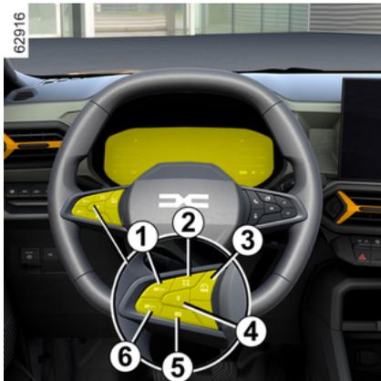
**1** Schalter zum Aktivieren und Erhöhen der Regelgeschwindigkeit ( **SET/+** ).
