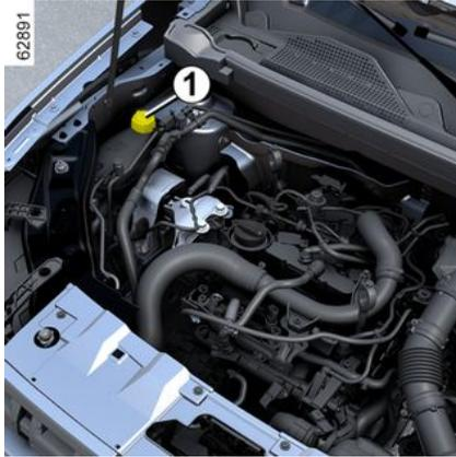
Bei abgeschaltetem Motor und Fahrzeug auf ebenem Untergrund stehend muss sich der Füllstand **bei kaltem** Motor zwischen den Marken „**MINI**“ und „**MAXI**“ am Kühlfüssigkeitsbehälter **1** befinden.
