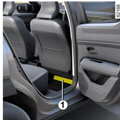
Stellen Sie sicher, dass keine Gegenstände oder Flüssigkeiten in die Luftdüse **1** gelangen.
