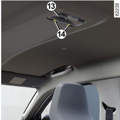
– Lösen Sie die Lampenfassung **13** durch Ausrasten der Laschen **14**;
