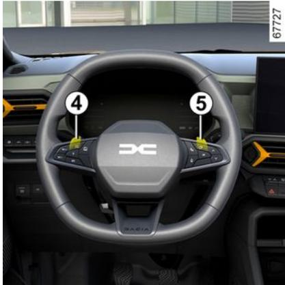
Je nach Fahrzeugausführung können Sie die Schaltwippen **4** und **5** zum Schalten der Gänge verwenden, wenn sich der Wahlhebel **1** in der Position **D** befindet.
