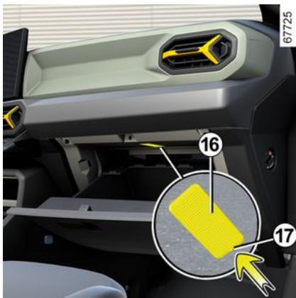
Die Leuchte **16** (mithilfe eines Schlitzschraubendrehers o. Ä.) lösen, indem Sie auf die Zunge **17** drücken, um die Leuchte in Richtung des Handschuhfachs zu bewegen
