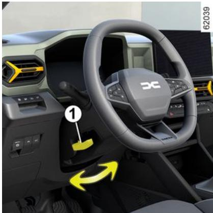
A seconda della versione del veicolo, l'altezza e la profondità del volante sono regolabili.
