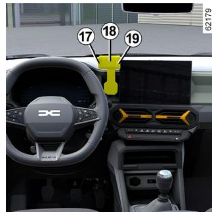
– posizionare il telefono nel relativo supporto **18** premendo la pinza fissa **17**, quindi rilasciare la pinza **19** in modo che il telefono sia mantenuto saldamente in posizione tra le pinze **17** e **19**.
