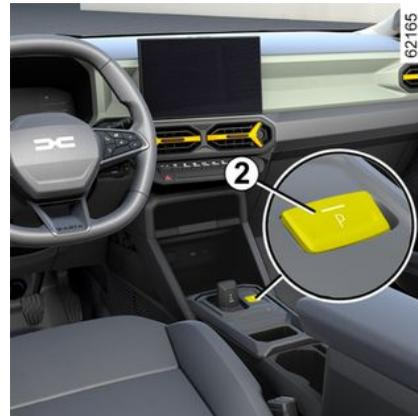
Con il veicolo fermo, il motore acceso o il contatto inserito, premere il pulsante **2** per innestare la posizione **P**. La spia sul pulsante **2** si accende in arancione quando si innesta la posizione di parcheggio **P** del cambio.
