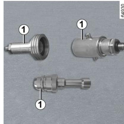
Se il personale della stazione di servizio esegue la procedura di rifornimento di GPL, è necessario fornire loro l'adattatore **1**.
