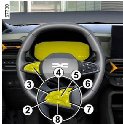
**2** Contattore per attivare e diminuire il limite di velocità (**SET/-**).
