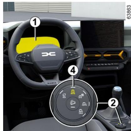
Per attivare questa modalità, ruotare il selettore **2** in posizione "**AUTO**" **4**: la spia del selettore si accende e la spia "**AUTO**" si accende sul quadro della strumentazione **1** per confermare l'attivazione.
