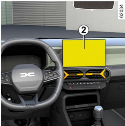
A seconda del veicolo, mentre l'accensione è inserita, è possibile disattivare il sistema tramite lo schermo multimediale **2**.
