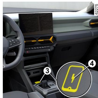
A seconda del veicolo, il simbolo 4 indica che l'area 3 può essere utilizzata per caricare il telefono senza bisogno di un cavo di ricarica.
