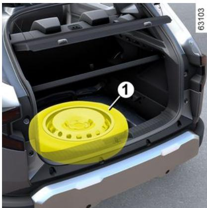
A seconda della versione del veicolo, rimuovere la cassetta degli attrezzi **A** e la ruota di scorta **1**.
