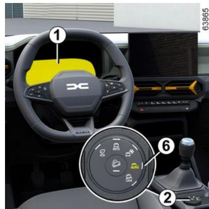
Per attivare questa modalità, ruotare il selettore **2** to the **"MUD-SAND"** **6**: la spia integrata nel selettore si accende e **"MUD-SAND"** viene visualizzato sul quadro della strumentazione **1** per confermare l'attivazione.
