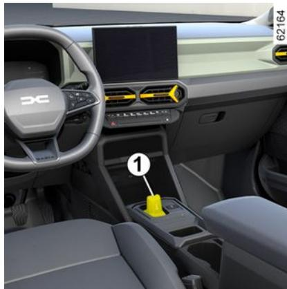
Spostare la leva del cambio **1** di una o due tacche in avanti o indietro per innestare la marcia desiderata (**R**, **N**, **D** o **B**), quindi rilasciare la leva del cambio che torna nella relativa posizione stabile.
