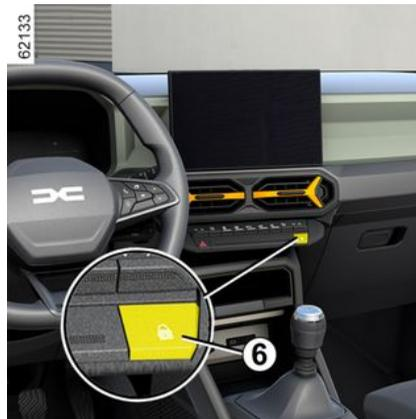
Il contattore **6** controlla le porte e la porta del bagagliaio e lo sportellino del serbatoio contemporaneamente.
