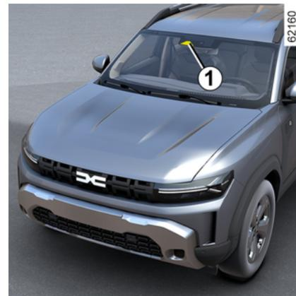
Il sistema visualizza i limiti di velocità sul quadro della strumentazione in base ai segnali rilevati sul bordo della strada.
