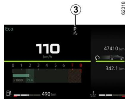
Il display **3** sul quadro della strumentazione indica la posizione della leva del cambio **1**.
