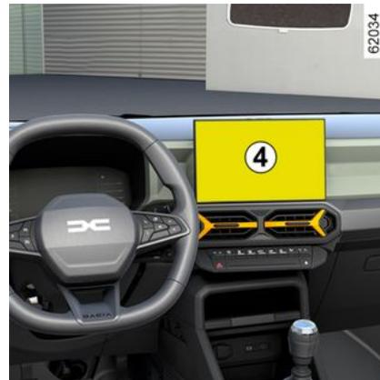
Le telecamere trasmettono quattro viste separate allo schermo **4**, permettendo così di avere una visuale chiara dell'area circostante il veicolo.
