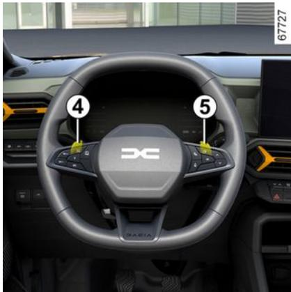
A seconda del veicolo, è possibile utilizzare le levette **4** e **5** per cambiare marcia con la leva del cambio **1** in posizione **D**.
