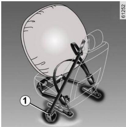
I pretensionatori servono a fare aderire la cintura al corpo dell'occupante del sedile, aumentando l'efficacia della cintura stessa.
