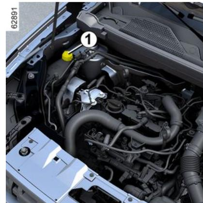
Con il motore spento e il veicolo in piano, il livello a **freddo** deve essere compreso tra i contrassegni "**MINI**" e "**MAXI**" indicati sul serbatoio del liquido di raffreddamento **1**.
