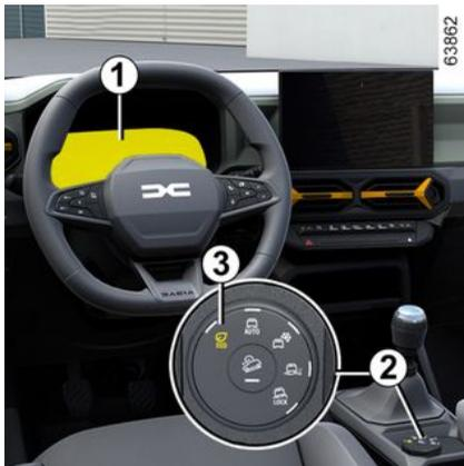
Per attivare questa modalità, ruotare il selettore **2** in posizione "**ECO**" **3**: la spia del selettore si accende e la spia "
