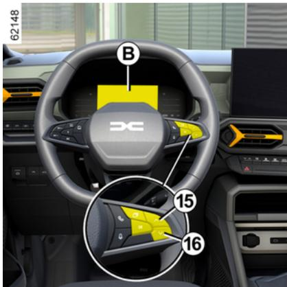
A seconda del veicolo, utilizzare il controllo **15** o **16** per accedere e selezionare i vari widget sul quadro della strumentazione:
