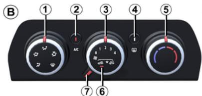
La levetta **7** consente di attivare e disattivare l'isolamento dell'abitacolo/ricircolo dell'aria.
