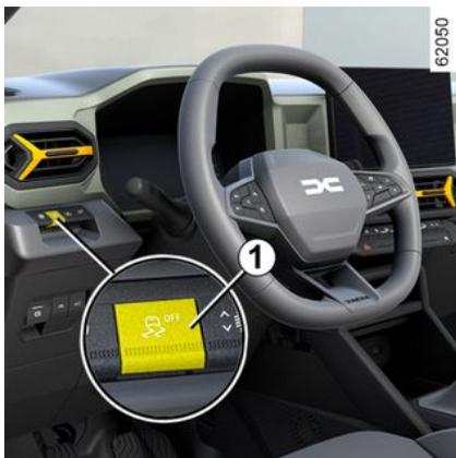
In alcune condizioni (guida su terreno molto bagnato: neve, fango e così via o catene montate), il sistema potrebbe ridurre la potenza del motore per limitare lo slittamento delle ruote. Per evitare che ciò si verifichi, è possibile disattivare la funzione tenendo premuto il contattore **1**.
