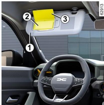
Abbassate l'aletta parasole **1** sul parabrezza o sganciatela e ruotatela sul vetro laterale.
