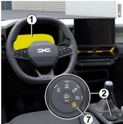
Per attivare questa modalità, ruotare il selettore **2** in posizione "OFF-ROAD" **7**: la spia integrata nel selettore si accende, "OFF-ROAD" viene visualizza-
