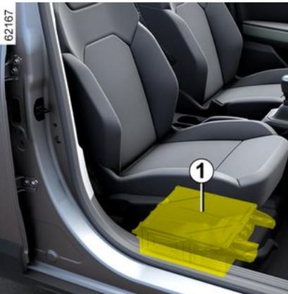
A seconda del veicolo, in un apposito vano sotto il sedile passeggero anteriore o sotto il sedile del conducente è presente una batteria secondaria **1** che fornisce l'energia necessaria per il funzionamento di alcuni sistemi.
