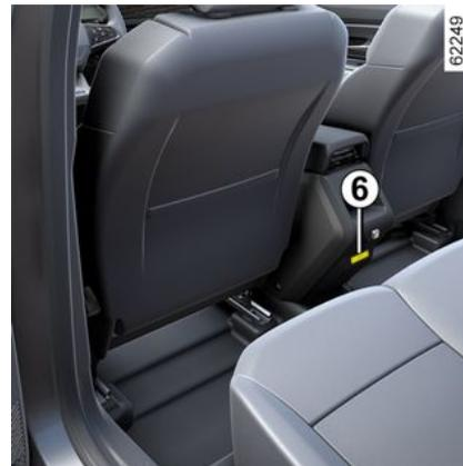
Le prese multimediali USB-C **2** e **6** possono essere utilizzate per caricare accessori con una potenza massima di 12 Watt (5 Volt) per presa.
