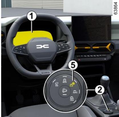
Per attivare questa modalità, ruotare il selettore **2** in posizione **"SNOW"** **5**: la spia del selettore si accende.
