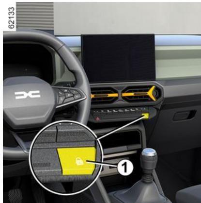
In seguito all'avviamento del veicolo, il sistema chiude automaticamente le porte non appena si raggiunge la velocità di circa 10 km/h.
