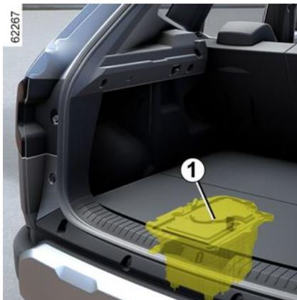
La batteria da 12 V **1** si trova nella parte posteriore del veicolo Hybrid e fornisce l'alimentazione necessaria per sbloccare/bloccare il veicolo, oltre che per utilizzare l'equipaggiamento.
