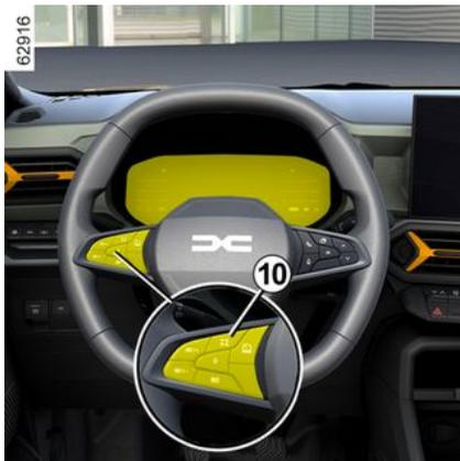
Per adattare l'impostazione di controllo del limitatore di velocità, del regolatore di velocità o, a seconda del veicolo, del regolatore di velocità adattivo Stop
