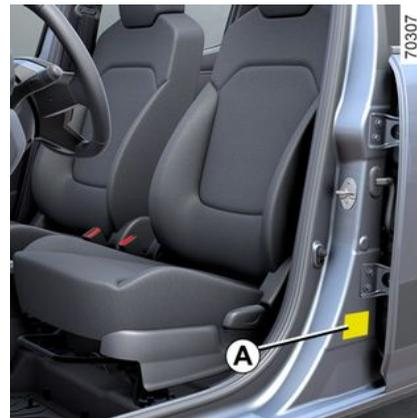
La pressione di gonfiaggio è indicata sull'etichetta **A** collocata sul lato anteriore della porta del conducente. La
