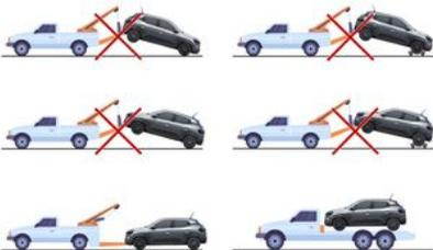
Il soccorso con carro attrezzi è **obbligatorio** in qualsiasi caso, ad eccezione dell'immobilizzazione del veicolo in seguito alla scarica completa della batteria di trazione. In caso di energia
