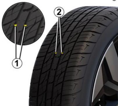
Gli pneumatici devono essere sempre in buono stato e il battistrada deve essere di spessore sufficiente; gli pneumatici approvati dai nostri Servizi Tecnici sono dotati di indicatori di usura **1** costituiti da **indicatori incorporati in**
