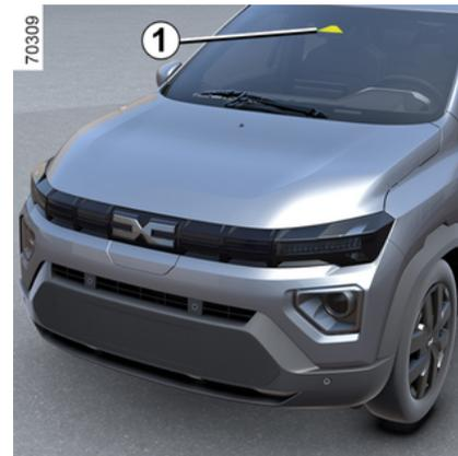
Grazie alle segnalazioni dalla telecamera **1**, la funzione attiva un'azione correttiva sul sistema sterzante del veicolo quando viene superata una linea continua o tratteggiata o in prossimità del bordo della strada (separatore, barriera, marciapiede, argine e così via) senza l'attivazione delle spie di direzione.
