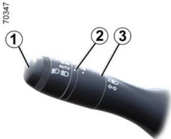
Se in dotazione al veicolo, le luci diurne si accendono automaticamente senza agire sulla levetta **1** all'avviamento del motore e si spengono allo spegnimento del motore.
