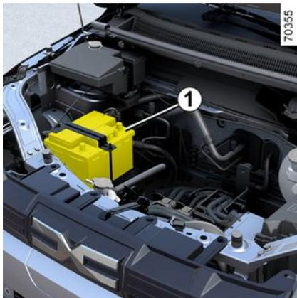
La batteria secondaria è una batteria 12 V: fornisce l'energia necessaria per il funzionamento dell'equipaggiamento del veicolo (luci, tergilavafari, sistema audio e così via) e di alcuni sistemi di sicurezza, come l'ABS.
