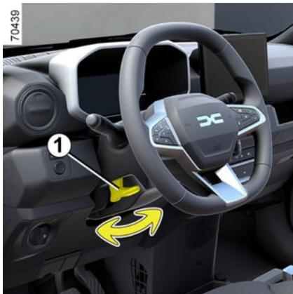
A seconda della versione del veicolo, l'altezza del volante è regolabile.
