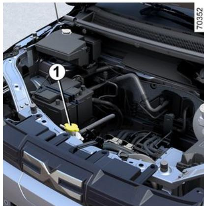
Controllare il livello su fondo piano, con il motore spento. **A freddo**, il livello deve essere compreso tra i livelli "MINI" e "MAXI" sul serbatoio **1**.
