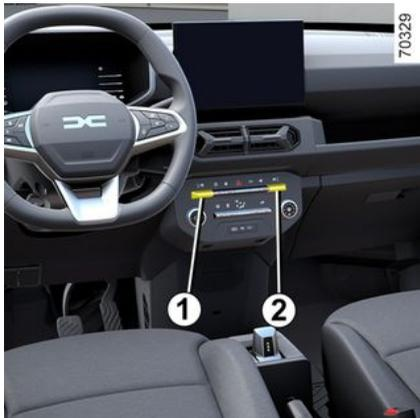
Premere la parte inferiore del contattore **1** o **2** per abbassare il vetro oppure la parte superiore del contattore **1** o **2** per alzarlo fino all'altezza desiderata.
