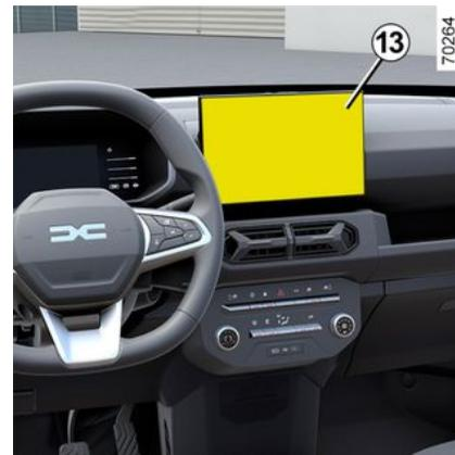
È possibile impostare il valore di soglia per il livello minimo di carica della batteria di trazione dallo schermo multimediale **13**.
