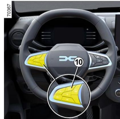
Per adattare l'impostazione di controllo del limitatore di velocità e del regolatore di velocità al limite di velocità rilevato, premere il contattore **10**.
