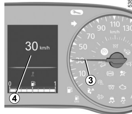
Indicateur de vitesse 3 et, suivant véhicule, 4 (km ou miles par heure)
