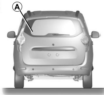
Le QR Code figurant sur l'étiquette **A** permet aux professionnels de secours au moyen d'une tablette ou d'un smartphone, d'accéder immédiatement aux informations techniques utiles pour une intervention sur le véhicule en cas d'accident.
