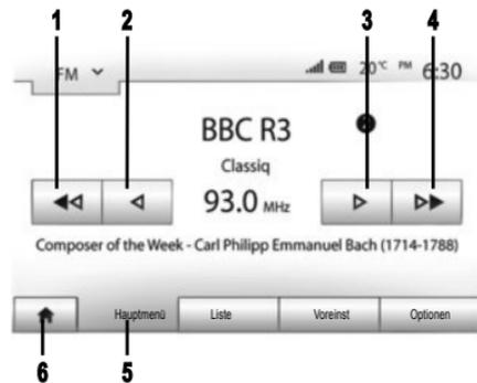
Um zum Radiomenü zu gelangen, drücken Sie „Home“ **6**, dann „Radio“. Wählen Sie den gewünschten Radio-Modus („AM“, „FM“ oder „DAB“), indem Sie **7** drücken.
