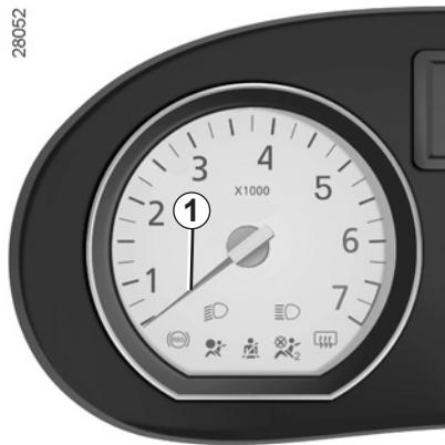
Otáčkoměr 1 (stupnice x 1000).
