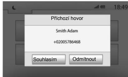
**Poznámka:** Příchozí hovor lze přijmout nebo odmítnout pomocí dálkového ovládání vozidla.
