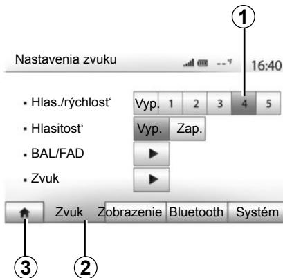
Stlačením tlačidla „Úvod“ > „Nastavenia“ sa zobrazí menu nastavení. Stlačením tlačidla **2** sa dostanete k parametrom zvuku.
