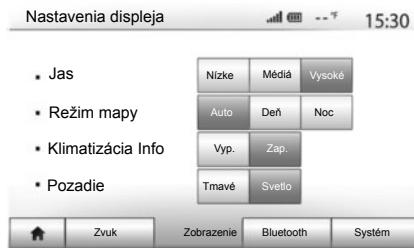
Ak sa chcete dostať k parametrom nastavenia multimediálneho systému, na úvodnej obrazovke stlačte tlačidlo „Nastavenia“ a vyberte položku v spodnej časti obrazovky.
