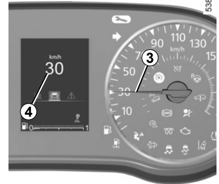
Tachometry 3 a, v závislosti na typu vozidla, 4 (km nebo míle za hodinu)
