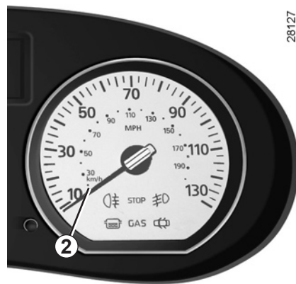
Ukazatel rychlosti 2 Dvojí stupnice pro zobrazení rychlosti (míle a km za hodinu) (podle vybavení vozidla)
