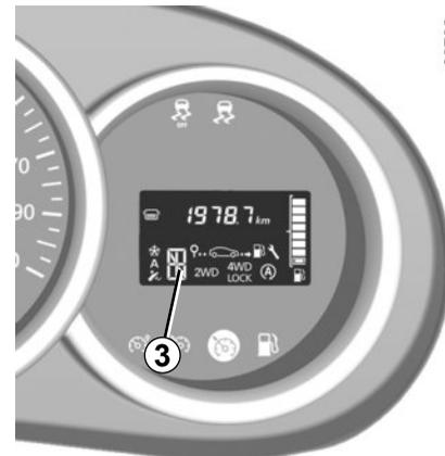
**Anzeige Automatikgetriebe 3**
