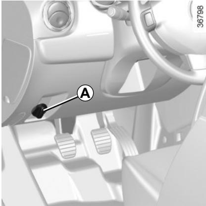
Je nach Fahrzeug lässt sich die Leuchtweite entsprechend der Fahrzeugbeladung mit Hilfe des Reglers **A** verstellen.
