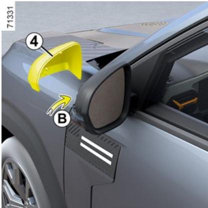
– die Schale **4** mit einem Schlitzschraubendreher o. Ä. lösen (Bewegung **B**);
