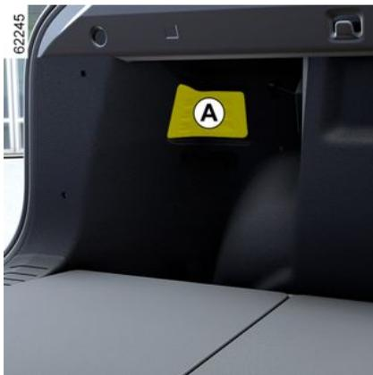
Öffnen Sie die Heckklappe und bauen Sie die Abdeckung **A** aus.
