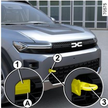
Um an die Abschleppöse 2 zu gelangen, lösen Sie die vordere Abdeckung 1, indem Sie einen Schlitzschraubendreher oder ein ähnliches Werkzeug in die Nut A unter die Abdeckung einführen.
