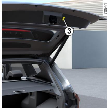
Sie können die maximale Öffnungshöhe der Heckklappe einstellen. Sie stoppt immer an der gewählten Position:
