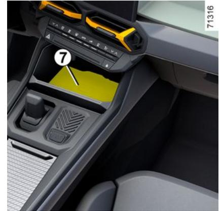
Je nach Fahrzeug zeigt das Symbol 8 an, dass der Bereich 7 verwendet werden kann, um Ihr Smartphone kabellos zu laden.
