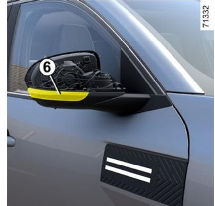
– die Abdeckung **6** des Blinkers **1** lösen, um an die Lampe zu gelangen;
