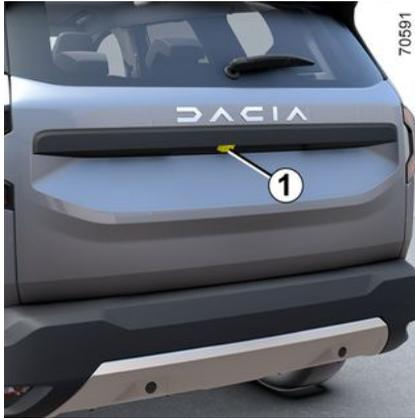
Wenn der Rückwärtsgang eingelegt wird, überträgt die Kamera **1** am Heck des Fahrzeugs auf dem Multimediadisplays **2** einen Blick auf den Bereich hinter dem Fahrzeug, begleitet von einer bis drei Maßlinien **3**, **4** oder **5** (fest, beweglich und Anhänger-Orientierungslinien).
