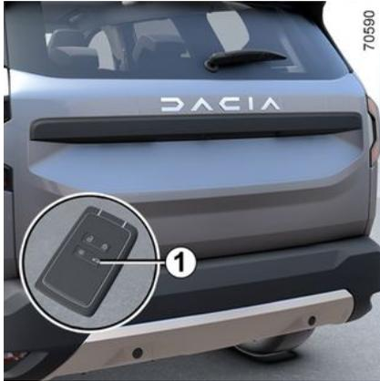
Bei ausgeschaltetem Motor die Taste **1** auf der Keycard gedrückt halten, während diese sich in der Nähe des Gepäckraums befindet.
