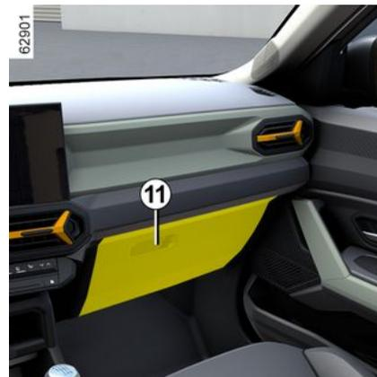
Ziehen Sie zum Öffnen am Griff **11**. Dieses Handschuhfach kann Dokumente im DIN-A4-Format aufnehmen. Die Innenseite der Handschuhfachklappe enthält ein Aufnahmefach für Stifte, Karten usw.
