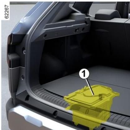
Die 12-V-Batterie **1** befindet sich hinten im Fahrzeug Hybrid: Diese liefert die Energie, die zum Entriegeln/Verriegeln des Fahrzeugs und zum Betrieb der elektrischen Verbraucher erforderlich ist.
