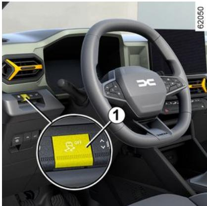
In bestimmten Situationen (Fahren auf sehr weichem Boden: Schnee, Schlamm, Sand usw. oder Fahren mit Schneeketten) verringert das System u. U. die Motorleistung, um ein Durchdrehen der Räder zu verhindern. Sollte die Funktion nicht erforderlich sein, drücken und halten Sie zum Deaktivieren den Schalter **1**.
