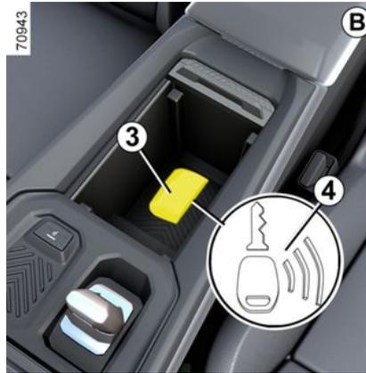
Betätigen Sie das Brems- oder das Kupplungspedal. Platzieren Sie dann die Keycard **3** (**A** oder **B**) auf dem Symbol **4** (**A** oder **B**). Drücken Sie den Knopf **1**, um das Fahrzeug zu starten. Die Meldung erlischt.
