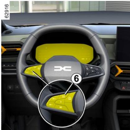
Drücken Sie den Schalter **6**, um die erkannte Geschwindigkeitsbegrenzung für die Geschwindigkeitsbegrenzungsbzw. -regelungsfunktion oder für den adaptiven Tempomaten Stop and Go zu übernehmen.
