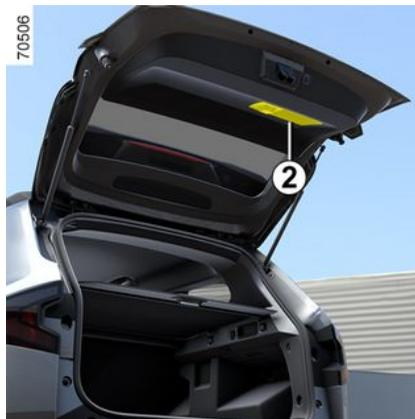
Ziehen Sie die Heckklappe nach unten, mithilfe des Griffs **2**.
