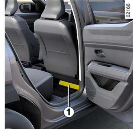
Stellen Sie sicher, dass keine Gegenstände oder Flüssigkeiten in die Luftdüse **1** gelangen.
