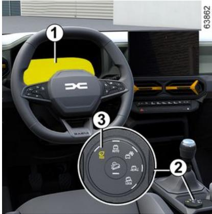
Um diesen Modus zu aktivieren, drehen Sie den Wahlschalter **2** in die Position „**ECO**“ **3**: Die Beleuchtung des Wahlschalters leuchtet auf und die
