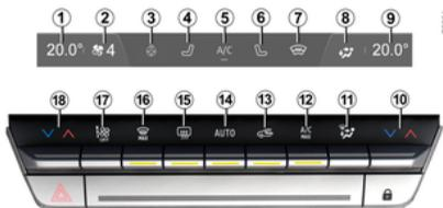
Im Funktionsmodus „Regelautomatik“ passt die Anlage die Gebläseleistung stets so an, dass das gewählte Raumklima erreicht und beibehalten wird.
