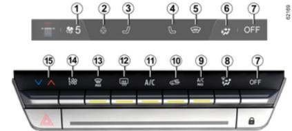
Drücken Sie **8** ein- oder mehrmals, um die Luftverteilung zu wählen. Die gewählte Luftverteilung **6** wird auf dem Multimedia-Display angezeigt. Die Stellungen sind in der folgenden Reihenfolge:
