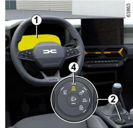
Um diesen Modus zu aktivieren, drehen Sie den Wahlschalter **2** in die Position **4** „**AUTO**“: Die Beleuchtung des Wahlschalters leuchtet auf und die Kontrollleuchte „**AUTO**“ erscheint in der Instrumententafel **1**, um die Aktivierung zu bestätigen.
