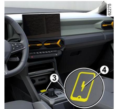
Je nach Fahrzeug zeigt das Symbol 4 an, dass der Bereich 3 verwendet werden kann, um Ihr Smartphone kabellos zu laden.
