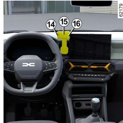
– das Telefon in die Telefonhalterung **15** durch Drücken der feststehenden Klemme **14** einsetzen, dann die Klemme **16** lösen, damit das Telefon fest zwischen den Klemmen **14** und **16** sitzt.
