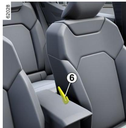
Drehen Sie den Griff **6**, um die Stütze zu erhöhen oder zu verringern.
