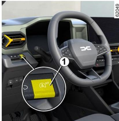
Drücken Sie den Schalter **1**, um die Funktion zu deaktivieren. An den Displays und Anzeigen erscheint die Meldung „Stop & Start deaktiviert“, und die Kontrolllampe des Schalters **1** leuchtet auf.
