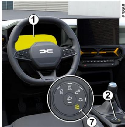
Um diesen Modus zu aktivieren, drehen Sie den Wahlschalter 2 in die Position „OFF-ROAD“ 7: Das im Wahlschalter integrierte Licht leuchtet auf, „OFF-ROAD“ wird angezeigt und die
