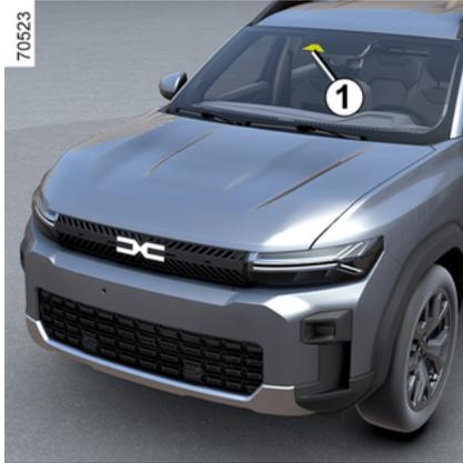
Diese Funktion nutzt Informationen von der Kamera **1** und informiert den Fahrer über den zeitlichen Abstand zwischen dem eigenen und dem vorausfahrenden Fahrzeug, sodass ein sicherer Abstand zwischen beiden Fahrzeugen gehalten werden kann.
