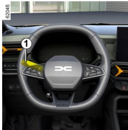
Sofern das Fahrzeug damit ausgestattet ist, werden das Tagfahrlicht und die hinteren Standleuchten beim Starten des Motors automatisch und ohne Betätigung des Schalters **1** ein- und nach Abstellen des Motors ausgeschaltet.
