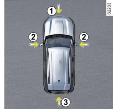
Wenn die vier Kameras **1**, **2** und **3** am Fahrzeug im vorderen Stoßfänger, an den Zusatzscheinwerfern und an der Heckklappe vorhanden sind, helfen sie Ihnen bei schwierigen Manövern.
