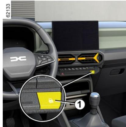
Nach dem Starten des Fahrzeugs verriegelt das System die Türen automatisch, sobald eine Geschwindigkeit von ca. 10 km/h erreicht wird.
