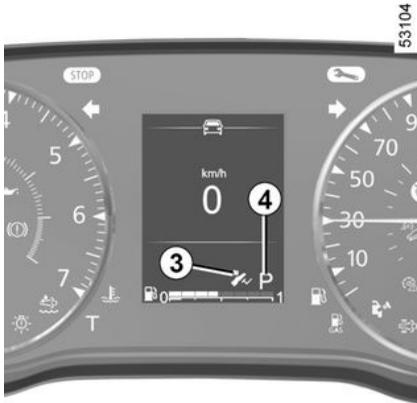
Mit dem Fuß auf dem Bremspedal (Warnleuchte **3** verschwindet aus der Anzeige), **P** auskuppeln.
