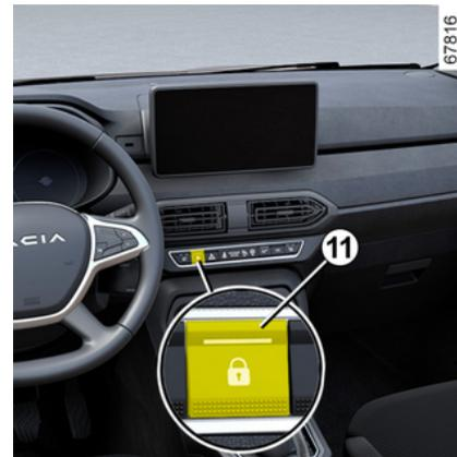
Je nach Fahrzeug können alle vier Türen und die Gepäckraumklappe gleichzeitig verriegelt bzw. entriegelt werden. Drücken Sie zum Ver- bzw. Entriegeln der Türen auf den Schalter **11**.
