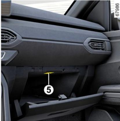
Das Licht **5** wird eingeschaltet, sobald die Klappe geöffnet wird.
