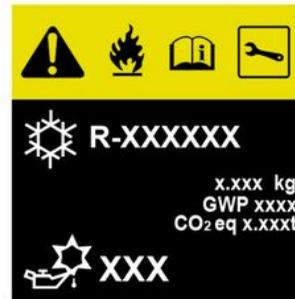
Der Kältemittelkreislauf (in dem einige Bauteile luftdicht verschlossen sind) kann fluoridierte Treibhausgase enthalten.
