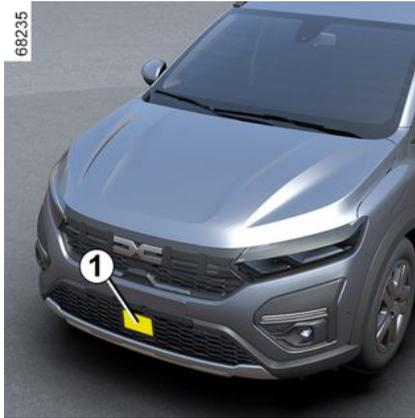
Aus den Radardaten **1** berechnet das System die Entfernung zu
