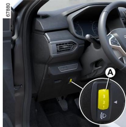
Mit der Steuerung **A** wird die Leuchtweite gemäß der Fahrzeugbeladung eingestellt.
