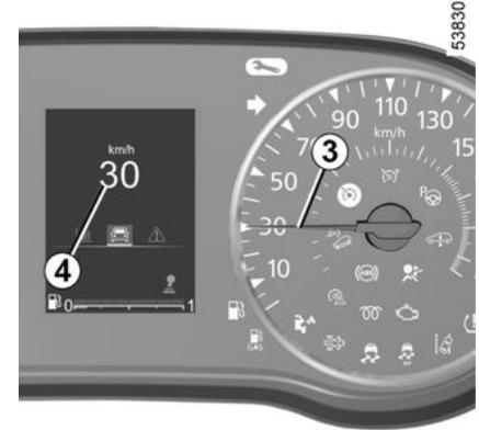
Behalten Sie Ihre Geschwindigkeit mit dem Tachometer **3** oder **4** unter Kontrolle. Bei Unterschieden zwischen den Tachometern halten Sie sich an den zugelassenen Tachometer **3** und wenden Sie sich an einen Vertragspartner.
