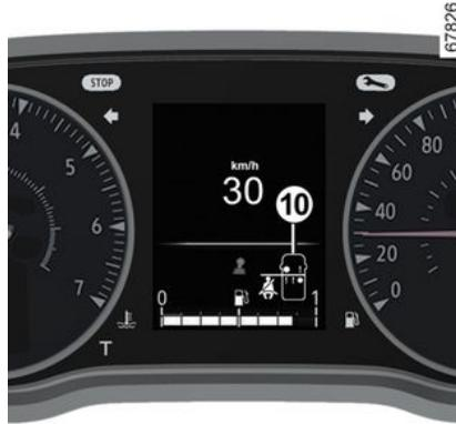
Je nach Fahrzeug wird die Grafik **10** ca. 60 Sekunden lang auf der Instrumententafel angezeigt, wenn die Zündung bei geschlossenen Türen eingeschaltet wird.
