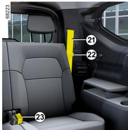
Lösen Sie den Gurt **21** vom Haken **24**. Langsam am Gurt ziehen **21**.
