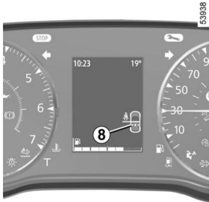
Je nach Fahrzeug wird die Grafik **8** auf der Instrumententafel angezeigt, wenn die Zündung eingeschaltet ist. Dies informiert den Fahrer jedes Mal über den Anlegestatus der einzelnen hinteren Sicherheitsgurte:
