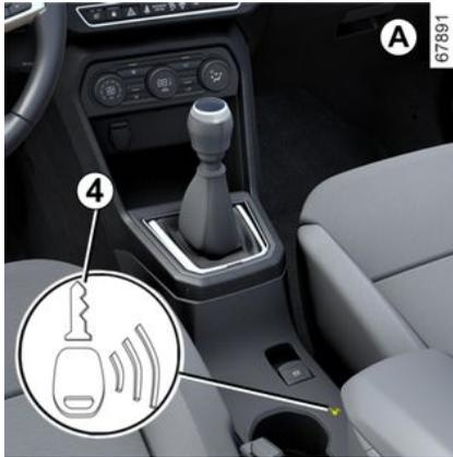
Betätigen Sie das Brems- oder das Kupplungspedal. Platzieren Sie dann die Keycard **3** (**A** oder **B**) auf dem Symbol **4** (**A** oder **B**). Drücken Sie den Knopf **2**, um das Fahrzeug zu starten. Die Meldung erlischt.
