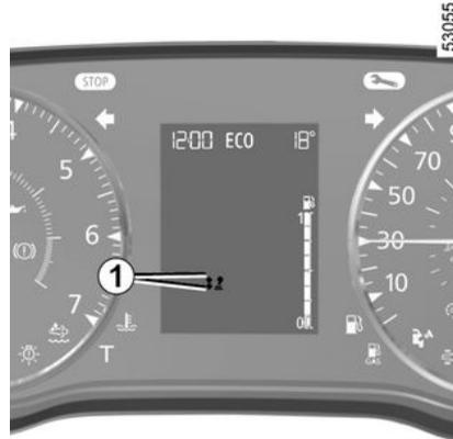
Je nach Fahrzeug informiert Sie eine Kontrolllampe in der Instrumententafel über den optimalen Zeitpunkt zum Hoch- oder Zurückschalten, um so den Kraftstoffverbrauch zu minimieren:
