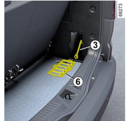
Entfernen Sie die Klappe **6**, um (je nach Fahrzeugmodell) an die Abschleppöse **3** zu gelangen.
