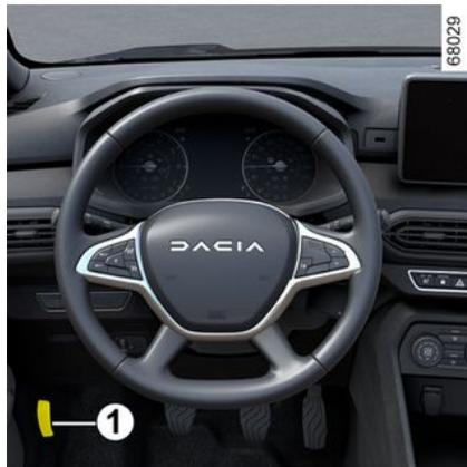
Um die Motorhaube zu öffnen, ziehen Sie bei geöffneter Tür am Griff **1** auf der linken Seite des Armaturenbretts.
