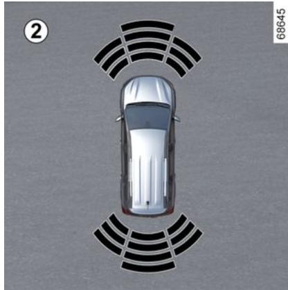
Je nach Fahrzeug wird zusätzlich zu den Signaltönen auf dem **2-Display** die Umgebung um das Fahrzeug angezeigt.
