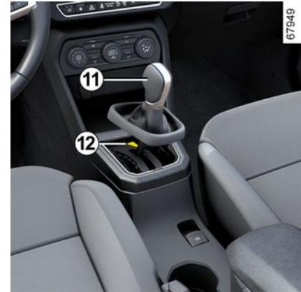
**Hängt der Fahrstufenwahlhebel beim Anfahren** beim Bremsen in Stellung **P** fest (z. B. Batteriefehler), kann er manuell gelöst werden, um die Antriebsräder freizugeben. Rasten Sie dazu die Manschettenbasis aus, und drücken Sie Drucktaste **12** und gleichzeitig die Taste **11** am Hebel, um den Hebel zu entriegeln und in die Stellung **N** zu bringen.
