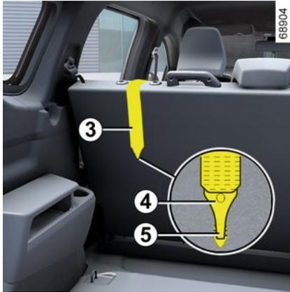
Der dritte Ring **5** wird zur Befestigung des oberen Gurtes an einigen Kindersitzen verwendet. **3** bei einigen Kindersitzen.
