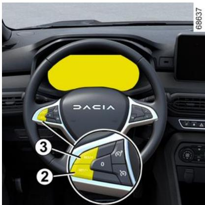
Die Regelgeschwindigkeit kann durch wiederholtes Drücken der folgenden Taste geändert werden:
