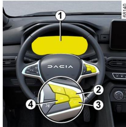
Wählen Sie auf der Anzeige „Tageskilometerzähler“ aus und drücken Sie auf die Taste **2** oder **3**, bis der Tageskilometerzähler auf Null zurückgesetzt wird.
