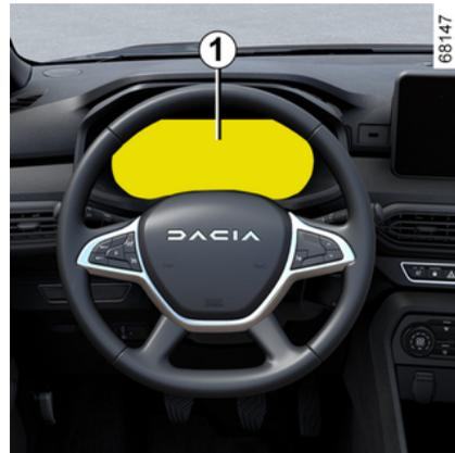
**Die Informationen an der Instrumententafel signalisieren mögliche Probleme mit dem Reifendruck (z. B. unzureichender Reifendruck oder Reifenpanne).** Zu Ihrer eigenen Sicherheit müssen Sie beim Aufleuchten
