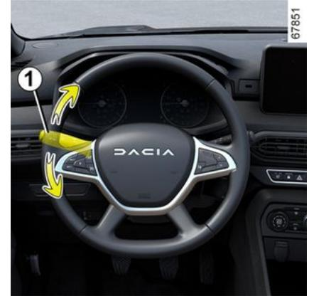
Bewegen Sie den Hebel **1** parallel zum Lenkrad in die Richtung, in die Sie es drehen möchten.
