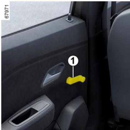
Betätigen Sie die Handkurbel **1** zum Öffnen oder Schließen des Fensters bis zur gewünschten Höhe.
