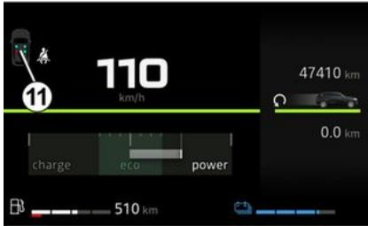
Je nach Fahrzeug wird die Grafik **11** ca. 60 Sekunden lang auf der Instrumententafel angezeigt, wenn die Zündung bei geschlossenen Türen eingeschaltet wird.
