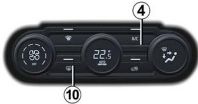
Im Funktionsmodus „Regelautomatik“ wird die Klimaanlage durch das System in Abhängigkeit von der Außentemperatur einund ausgeschaltet, um das gewählte Raumklima zu erreichen oder zu halten.
