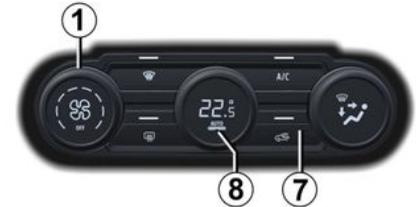
Diese Funktion wird automatisch gesteuert, Sie können sie jedoch auch manuell aktivieren. In diesem Fall wird der Betrieb durch die Kontrolllampe über der Taste **7** bestätigt.
