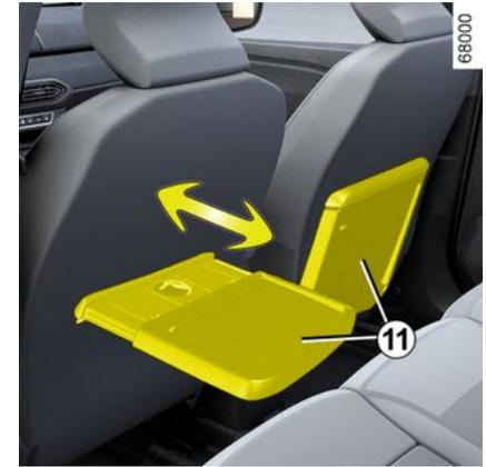
Heben Sie das Ablagefach in die waagerechte Stellung an.
