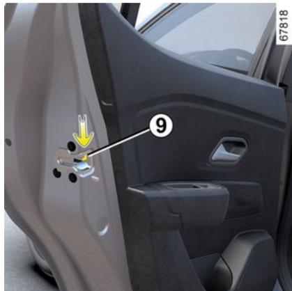
Drehen Sie bei geöffneter Tür den Hebel **9** (mit dem Ende des Schlüssels) und schließen Sie die Tür.
