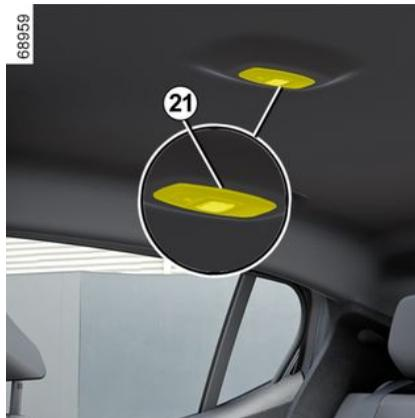
Drücken Sie die Lasche an einer Seite der Deckenleuchte hinten **21** mit einem Flachklingen-Schraubendreher ein und rasten Sie die Deckenleuchte aus, sodass die Glühlampe zugänglich ist.
