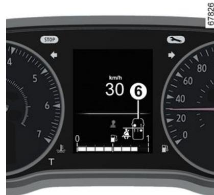
Je nach Fahrzeug wird die Grafik **6** ca. 60 Sekunden lang auf der Instrumententafel angezeigt, wenn die Zündung bei geschlossenen Türen eingeschaltet wird.
