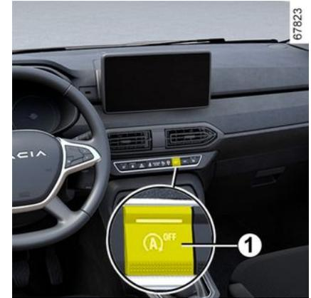
Drücken Sie den Schalter **1**, um die Funktion zu deaktivieren. An den Displays und Anzeigen erscheint die Meldung „Stop & Start deaktiviert“, und die Kontrolllampe des Schalters **1** leuchtet auf.
