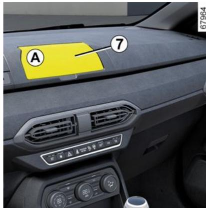
Heben Sie an entsprechend ausgestatteten Fahrzeugen die Klappe **7**, platzieren Sie Ihr Telefon **10** horizontal in der Halterung **8** und schließen Sie die Klappe **7**, während sie das Telefon in der Halterung **9** in Position halten.
