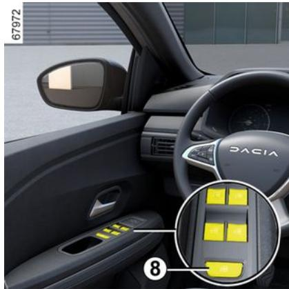
Oben auf den Schalter **8** drücken, um die hinteren Fensterheber zu verriegeln oder unten auf den Schalter **8**, um sie zu entriegeln.
