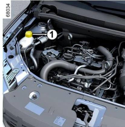
Bei abgeschaltetem Motor und Fahrzeug auf ebenem Untergrund stehend muss sich der Füllstand **bei kaltem Motor** zwischen den Marken „MINI“ und „MAXI“ am Kühlflüssigkeitsbehälter **1** befinden.
