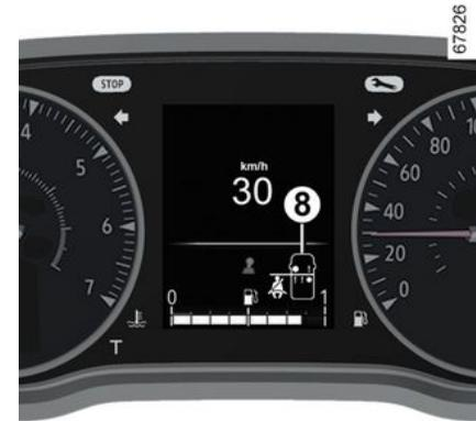
Je nach Fahrzeug wird die Grafik 8 ca. 60 Sekunden lang auf der Instrumententafel angezeigt, wenn die Zündung bei geschlossenen Türen eingeschaltet wird.
