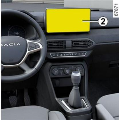
Wählen Sie bei stehendem Fahrzeug und laufendem Motor auf dem Multimedia-Bildschirm **2** das Menü „EINSTELLUNGEN“, wählen Sie auf der Registerkarte „FAHRZEUG“ das Menü „FAHRASSISTENZ“ und dann „Toter Winkel“, „ON“ oder „OFF“.
