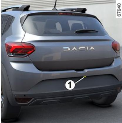
Wenn der Rückwärtsgang eingelegt wird, zeigt die in der Nähe der Nummernschildbeleuchtung befindliche Kamera **1** auf dem Multimedia-Display **2** eine Ansicht des Bereichs hinter dem Fahrzeug, begleitet von zwei beweglichen oder festen Führungslinien **3** und **4**.
