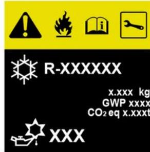
Der Kältemittelkreislauf (in dem einige Bauteile luftdicht verschlossen sind) kann fluorierte Treibhausgase enthalten.
