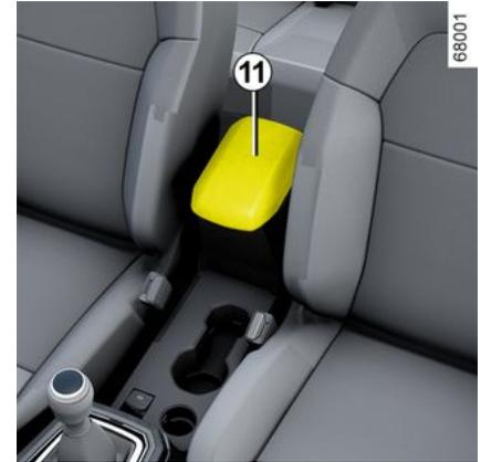
Heben Sie den Deckel 11 der mittleren Armlehne 13 mit der Griffplatte 12 an.
