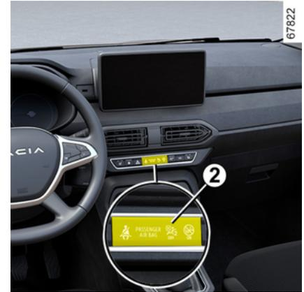
**Reaktivieren von airbag : Bei stehendem Fahrzeug und ausgeschalteter Zündung**, die Verriegelung **1** in die Position **ON** drücken und drehen.
