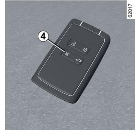
Die Taste **4** drücken, um die Innenbeleuchtung, das Standlicht und das Abblendlicht für ca. 20 Sekunden einzuschalten. Dies ermöglicht es beispielsweise, das Fahrzeug in einem Parkhaus zu orten.
