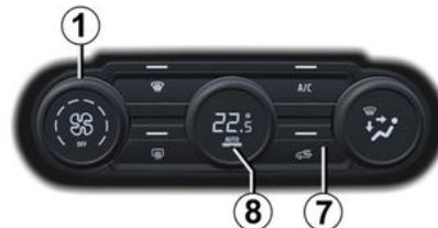
Diese Funktion wird automatisch gesteuert, Sie können sie jedoch auch manuell aktivieren. In diesem Fall wird der Betrieb durch die Kontrolllampe über der Taste **7** bestätigt.
