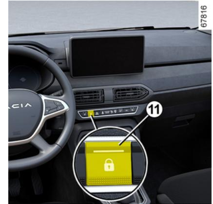
Je nach Fahrzeug können alle vier Türen und die Gepäckraumklappe gleichzeitig verriegelt bzw. entriegelt werden. Drücken Sie zum Ver- bzw. Entriegeln der Türen auf den Schalter **11**.
