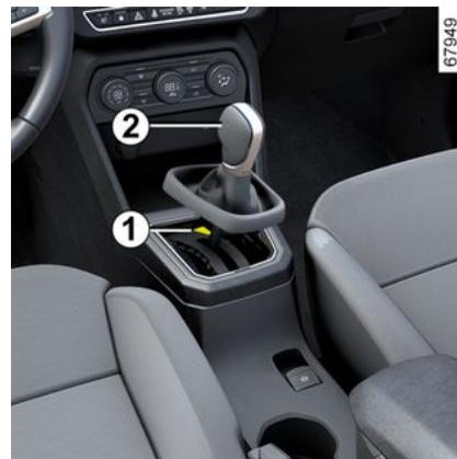
**Hängt der Fahrstufenwahlhebel beim Anfahren** beim Bremsen in Stellung **P** fest (z. B. Batteriefehler), kann er manuell gelöst werden, um die Antriebsräder freizugeben. Rasten Sie dazu die Manschettenbasis aus, und drücken Sie die Taste **1** und gleichzeitig die Taste **2** am Hebel, um den Hebel zu entriegeln und in die Stellung **N** zu bringen.
