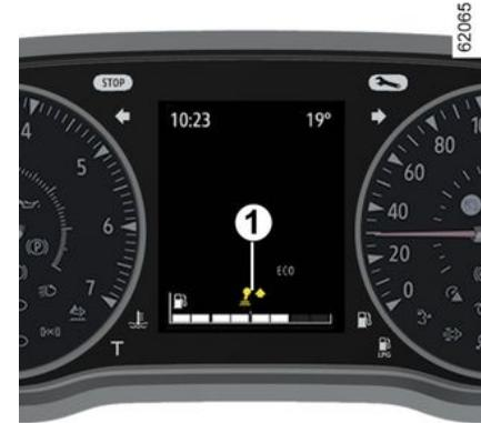
Bei regelmäßiger Überwachung dieser Anzeige kann der Kraftstoffverbrauch des Fahrzeugs gesenkt werden.
