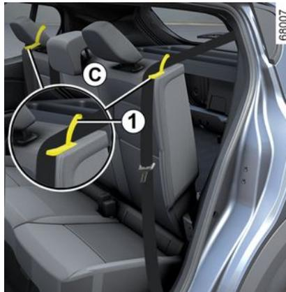
Je nach Fahrzeug zum Entriegeln der Sitzbank **C** gleichzeitig an den Laschen **1** ziehen, um sie von innen zu entriegeln.
