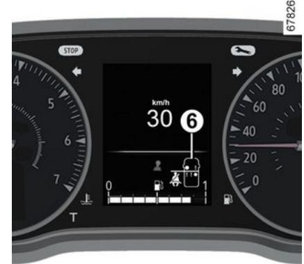
Je nach Fahrzeug wird die Grafik **6** ca. 60 Sekunden lang auf der Instrumententafel angezeigt, wenn die Zündung bei geschlossenen Türen eingeschaltet wird.
