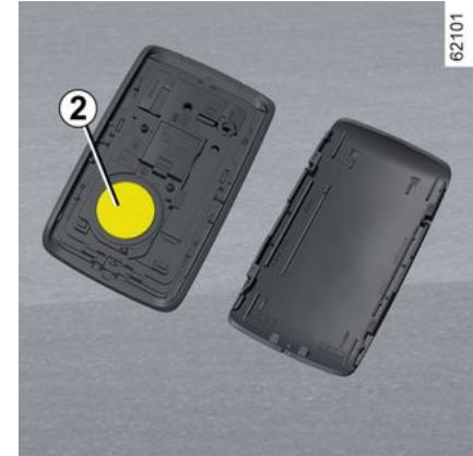
Gehen Sie für den Wiedereinbau in umgekehrter Ausbaureihenfolge vor. Drücken Sie anschließend viermal in Fahrzeughöhe auf eine der Keycard-Tasten: Beim nächsten Startvorgang erscheint die Meldung nicht mehr.
