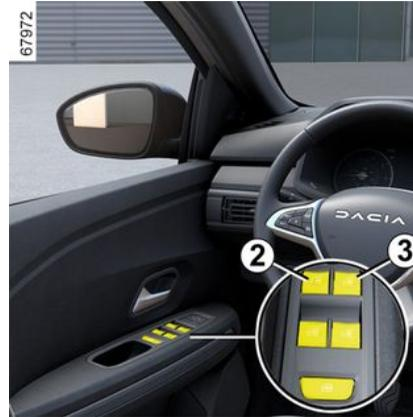
Die elektrischen Fensterheber funktionieren bei eingeschalteter Zündung.
