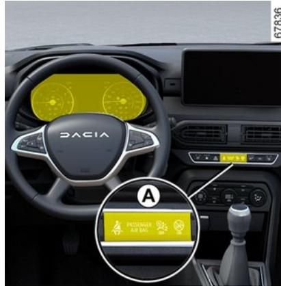
Diese Kontrolllampe leuchtet auf der zentralen Anzeige **A** auf, wenn bei eingeschalteter Zündung für einen besetzten Sitz des Fahrers und/oder Beifahrers und/oder im hinteren Fahrgastraum der zugehörige Sicherheitsgurt nicht angelegt ist.
