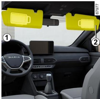
Klappen Sie die Sonnenblende **1** oder **2** über die Windschutzscheibe nach unten, oder rasten Sie diese aus, um sie zum Seitenfenster hin zu drehen.
