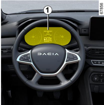
Das System zeigt an der Instrumententafel **1** den Reifendruck an und warnt den Fahrer bei nicht ausreichendem Reifendruck.
