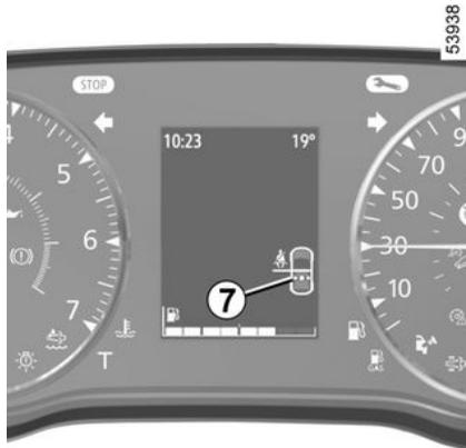
Je nach Fahrzeug wird die Grafik 7 auf der Instrumententafel angezeigt, wenn die Zündung eingeschaltet ist. Dies informiert den Fahrer jedes Mal über den Anlegestatus der einzelnen hinteren Sicherheitsgurte:
