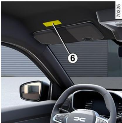
Verwenden Sie das Mikrofon **6** und die Bedieneinheit am Lenkrad **4**.
