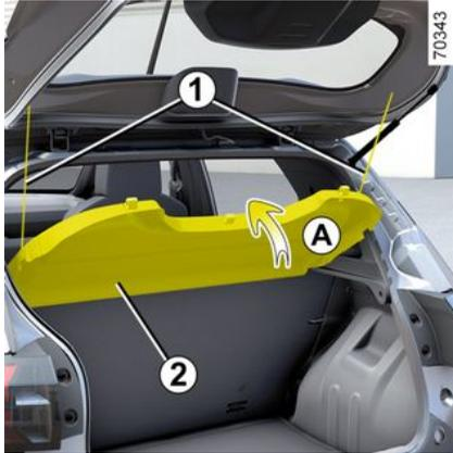
Die Heckablage **2** wird beim Öffnen der Heckklappe automatisch angeheben.
