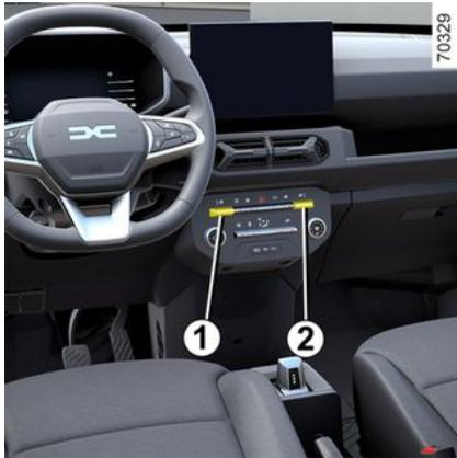
Drücken Sie unten auf den Schalter **1** oder **2**, um das Fenster zu öffnen oder drücken Sie oben auf den Schalter **1** oder **2**, um das Fenster bis zur gewünschten Position zu schließen.
