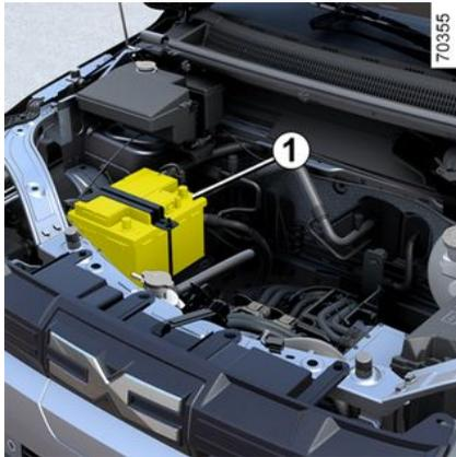
Die Zusatzbatterie ist eine 12-V-Batterie. Sie liefert Energie für den Betrieb der Fahrzeugausrüstung (Scheinwerfer, Scheibenwischer, Audiosystem usw.) und bestimmter Sicherheitssysteme wie ABS.
