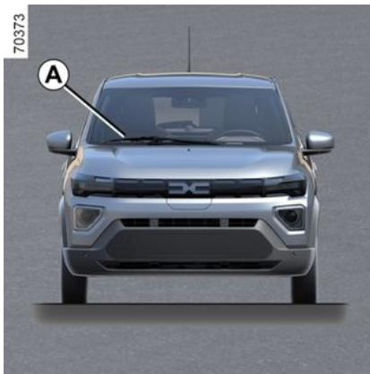
Der QR-Code auf dem Aufkleber **A** ermöglicht es den Einsatzkräften, mit einem Tablet oder Smartphone sofort auf die technischen Informationen zuzugreifen, die für die Maßnahmen am Fahrzeug bei einem Unfall nützlich sind.
