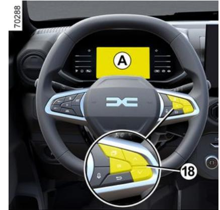
**Informationsbereich 17**, je nach Fahrzeug können Sie mit dem Bedienelement **18** die verschiedenen Widgets in der Instrumententafel **A** durchblättern und auswählen:
