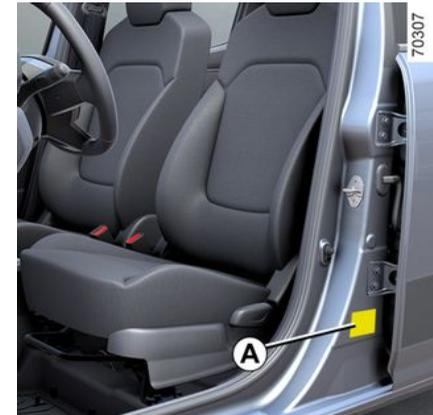
Der Reifendruck ist auf dem Aufkleber **A** an der Fahrertür ersichtlich. Der Reifendruck muss bei kalten Reifen gemessen werden.
