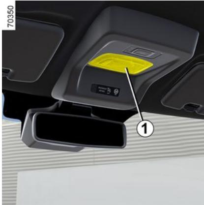
Die Deckenleuchte **1** mittels eines Schlitzschraubendrehers o. Ä. lösen.
