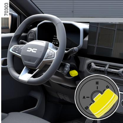
Verriegeln: Den Schlüssel abziehen und das Lenkrad bewegen, bis das Lenkradschloss einrastet.
