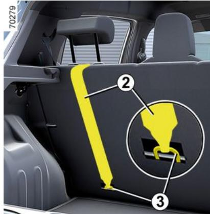
Schieben Sie den Gurt **2** zwischen Rückenlehne und Gepäckraumabdeckung. Entfernen Sie dazu zuerst die Gepäckraumabdeckung. Bringen Sie den Gurthaken an einem der mit dem
