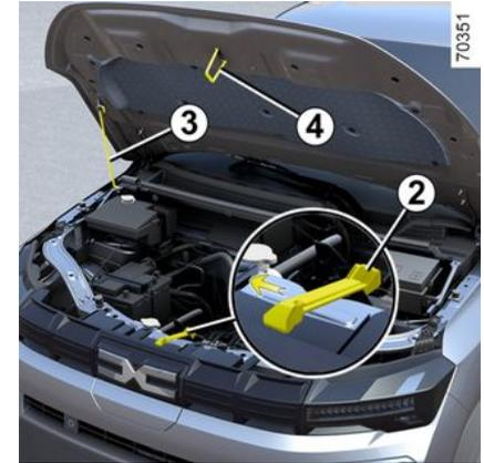
Zum Schließen der Motorhaube die Haltestange **3** aus der Aufnahme nehmen und in die Halteklammer einrasten. Auf 30 cm über die geschlossene Position absenken und loslassen. Sie verriegelt sich durch ihr Eigengewicht.
