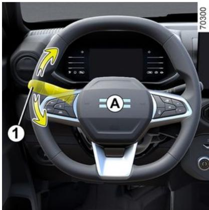
Drücken Sie auf die Lenkradnabe **A**, um das Signalhorn zu aktivieren.
