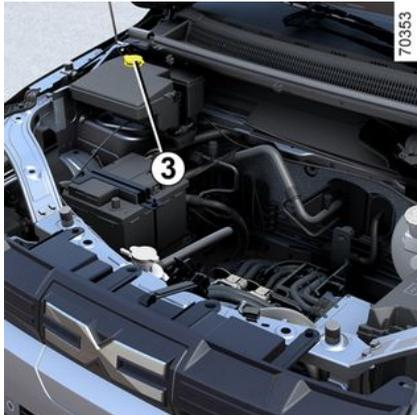
Die Kontrolle des Füllstandes erfolgt bei abgestelltem Motor auf ebener Fläche.
