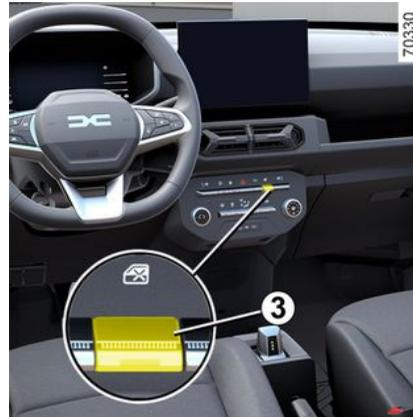
Für den Fahrer, um den Betrieb der hinteren elektrischen Fensterheber zu verhindern
