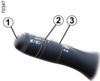
Falls im Fahrzeug vorhanden, wird das Tagfahrlicht beim Starten des Motors automatisch eingeschaltet, ohne dass es einer Betätigung des Hebels **1** bedarf, und erlischt beim Abstellen des Motors.
