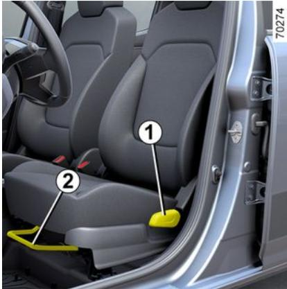
Heben Sie den Knopf **1** an, um die Rückenlehnenverstellung zu entriegeln. Klappen Sie dann den Sitz nach hinten in die gewünschte Position und lassen den Zugknopf los. Stellen Sie sicher, dass die Rückenlehne nach dem Loslassen ordnungsgemäß verriegelt ist.
