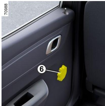
Drehen Sie je nach Fahrzeug den Drehregler **6** gegen den Uhrzeigersinn, um die Scheibe abzusenken, oder im Uhrzeigersinn, um die Scheibe auf die gewünschte Höhe anzuheben.
