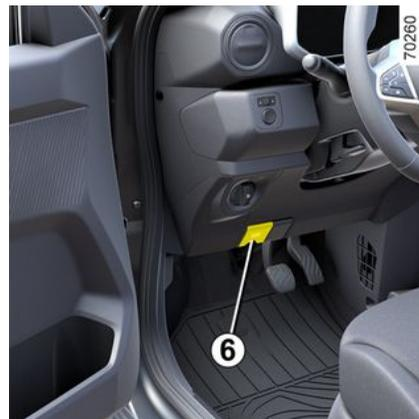
Ziehen Sie am Bedienelement **6**, um die Ladeklappe **9** zu entriegeln.
