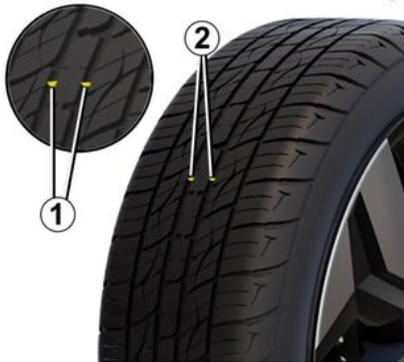
Die Reifen müssen in einwandfreiem Zustand sein und ihre Laufflächen müssen ein ausreichendes Profil aufweisen; die vom Hersteller zugelassenen Reifen sind mit einer Verschleißkontrolle **1** versehen. Es handelt sich dabei um **Verschleißanzeigen im Reifenprofil, die über die Lauffläche verteilt sind.**
