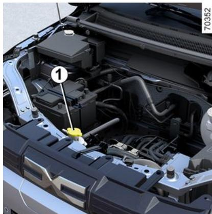
Das Niveau auf einem ebenen Untergrund bei abgeschaltetem Motor prüfen. **Im kalten Zustand** muss das Niveau zwischen den Markierungen „MINI“ und „MAXI“ des Behälters **1** liegen.
