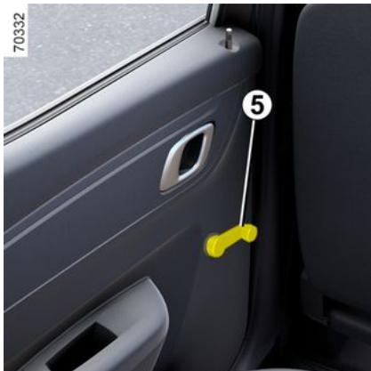
Betätigen Sie die Handkurbel **5** zum Öffnen oder Schließen des Fensters bis zur gewünschten Höhe.
