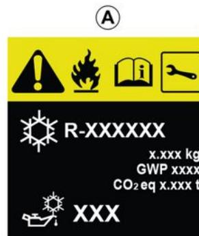
Der Kältemittelkreislauf (in dem einige Bauteile luftdicht verschlossen sind) kann fluorierte Treibhausgase enthalten.
