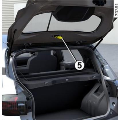
Den Lampenträger **5** um eine Vierteldrehung drehen, dann herausziehen und die Lampe entnehmen.
