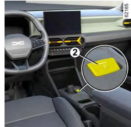
Bei stehendem Fahrzeug, laufendem Motor oder eingeschalteter Zündung drücken Sie auf die Taste **2**, um die Position **P** einzulegen. Die Warnlampe des Schalters **2** leuchtet orangefarben, sobald die Park-Stellung **P** des Getriebes eingelegt ist.
