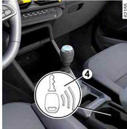
Treten Sie das Brems- oder Kupplungspedal, und halten Sie dann die Keycard **3** an das Symbol **4**. Drücken Sie den Knopf **1**, um das Fahrzeug zu starten. Die Meldung erlischt.
