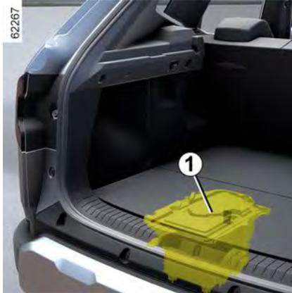
Die 12-V-Zusatzbatterie **1** befindet sich hinten im hybrid-Fahrzeug: Diese liefert die Energie, die zum Entriegeln/Verriegeln des Fahrzeugs und zum Betrieb der elektrischen Verbraucher erforderlich ist.
