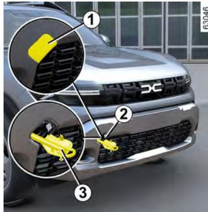
**Die Abschleppöse 3 fest anziehen:** Zuerst von Hand an den Anschlag drehen, dann mit dem Radschlüssel fest nachziehen.
