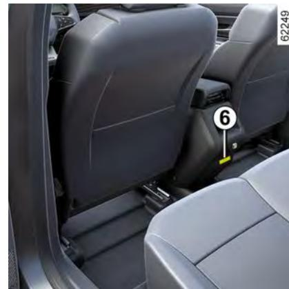
Die USB-C-Multimedia-Anschlüsse **3** und **6** ermöglichen das Aufladen von Zubehör, das von unserer technischen Abteilung zugelassen wurde, sofern die Leistung 12 Watt (5 V) pro Steckdose nicht überschreitet.
