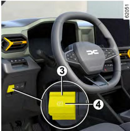
Um die elektrische Parkbremse manuell anzulegen (z. B. beim Halt an einer roten Ampel, im Stand bei laufendem Motor usw.), ziehen Sie den Schalter **4** und lassen ihn wieder los. Die Parkbremse wird beim Anfahren automatisch gelöst.
