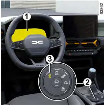
Um diesen Modus zu aktivieren, drehen Sie den Wahlschalter **2** in die Position „**ECO**“ **3**: Die Beleuchtung des Wahlschalters geht an und die
