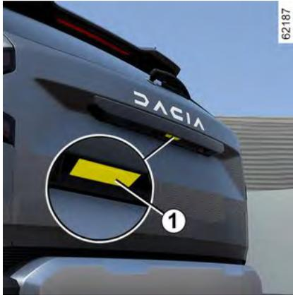
Drücken Sie die Taste **1** und heben Sie die Gepäckraumklappe an.
