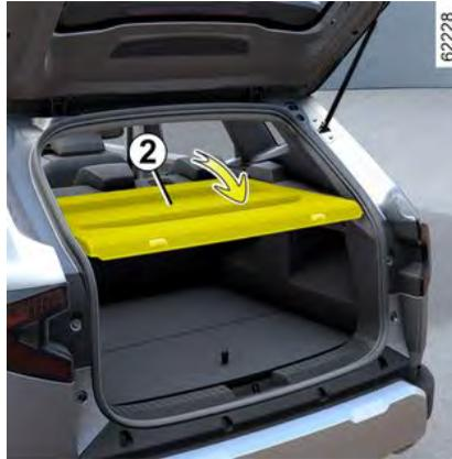
Heben Sie die Heckablage **2** leicht an und ziehen Sie sie zu sich heran, indem Sie die Enden halten.
