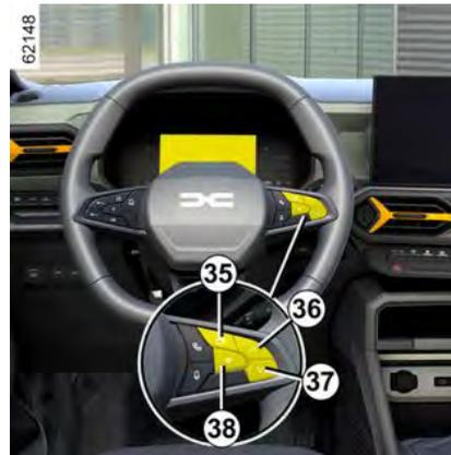
Den Schalter **35** drücken, um den Bereich „Fahrzeug“ aufzurufen, dann den Schalter **36** oder **37** drücken, bis **34** angezeigt wird.
