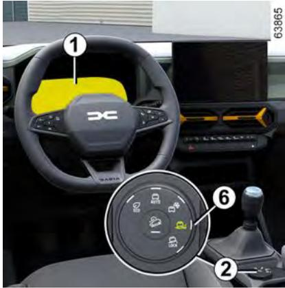
Um diesen Modus zu aktivieren, drehen Sie den Wahlschalter **2** in die Position „**MUD-SAND**“ **-6**: Das im Wahlschalter integrierte Licht leuchtet auf und „**MUD-SAND**“ wird auf der Instrumententafel **1** angezeigt, um die Aktivierung zu bestätigen.
