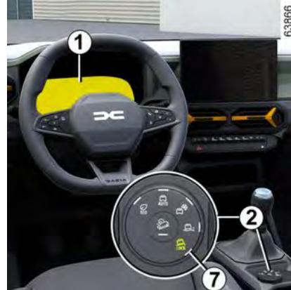
Um diesen Modus zu aktivieren, drehen Sie den Wahlschalter **2** in die Position „**OFF-ROAD**“ **7**: Das im
