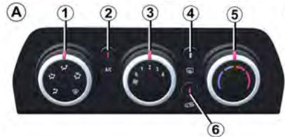
Mit der Taste **6** kann der Umluftbetrieb/Luftumwälzfunktion aktiviert (Warnleuchte an) oder deaktiviert (Warnleuchte aus) werden.
