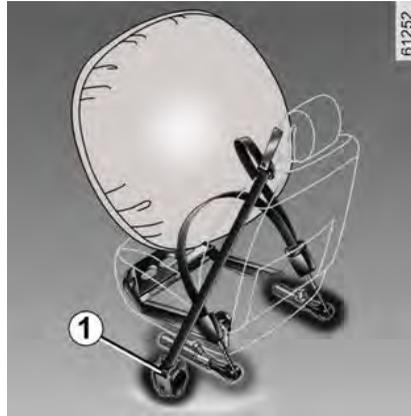
Die Gurtstraffer ziehen den Sicherheitsgurt an den Körper, um den Insassen auf seinem Sitz zu halten und erhöhen dadurch die Wirksamkeit. Bei eingeschalteter Zündung kann das System nach einem starken Frontalaufprall und abhängig von der Schwere des Aufpralls den Gurtstraffer **1** auslösen, der den Sicherheitsgurt sofort aufrollt.
