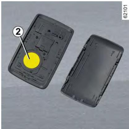
Gehen Sie für den Wiedereinbau in umgekehrter Ausbaureihenfolge vor. Drücken Sie anschließend viermal in Fahrzeughöhe auf eine der Keycard-Tasten: Beim nächsten Startvorgang erscheint die Meldung nicht mehr. Stellen Sie sicher, dass der Deckel richtig eingerastet ist.
