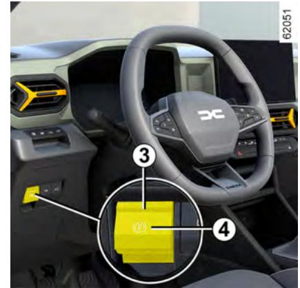
Der Anzug der Servo-Parkbremse wird durch die Meldung „Parkbremse angezogen“ und die Kontrolllampe
