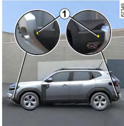
Diese Funktion verwendet Sensoren **1**, die sich an beiden Seiten der vorderen und hinteren Stoßfänger befinden.
