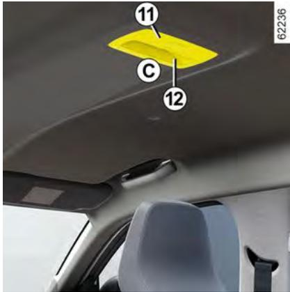
– Lösen Sie die Streuscheibe **12** mit einem Flachklingen-Schraubendreher an der Position **C**.
