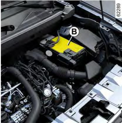
Der **A**-Aufkleber befindet sich auf Batterie **1** unter der Schutzabdeckung **B**.
