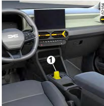
Bewegen Sie den Wahlhebel **1** eine oder zwei Kerben vor oder zurück, um die gewünschte Position zu schalten (**R**, **N**, **D** oder **B**), dann lassen Sie den Hebel los und er kehrt in seine stabile Position zurück.
