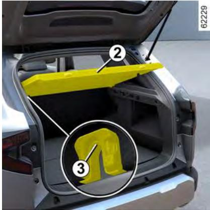
Heben Sie die Heckablage **2** zur Hälfte an und lösen Sie die Befestigungen **3** an jedem Ende der Ablage.
