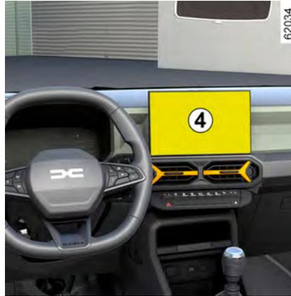
Der Automatikmodus wird aktiviert, wenn der Rückwärtsgang eingelegt und auf dem Bildschirm **4** die Rückfahrkameraansicht angezeigt wird. Bei einem schneller Wechsel vom Rückwärtsgang in einen Vorwärtsgang zeigt der Bildschirm **4** das von der Frontkamera übertragene Bild an.
