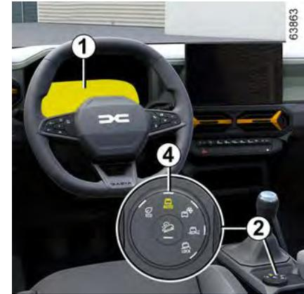
Um diesen Modus zu aktivieren, drehen Sie den Wahlschalter **2** in die Position „**AUTO**“ **4**: Das im Wahlschalter integrierte Licht leuchtet auf und „**AUTO**“ wird an der Instrumententafel **1** angezeigt, um die Aktivierung zu bestätigen.
