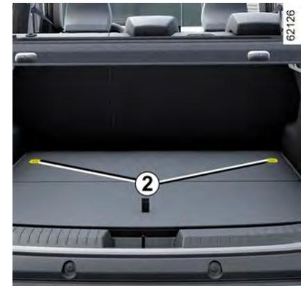
Der dritte Ring der beiden seitlichen Sitzplätze dient zur Befestigung des oberen Haltegurts einiger Kindersitze. Führen Sie den Gurt zwischen der Rückenlehne und der Heckablage hindurch (zum Ausbau der Heckablage → 306).
