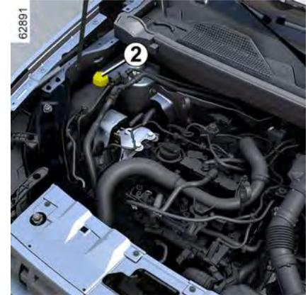
Bei ausgeschalteter Zündung und mit dem Fahrzeug auf ebener Fläche stehend muss der Füllstand in **kaltem Zustand** zwischen den Markierungen „MINI“ und „MAXI“ im Kühflüssigkeitsbehälter **2** liegen.
