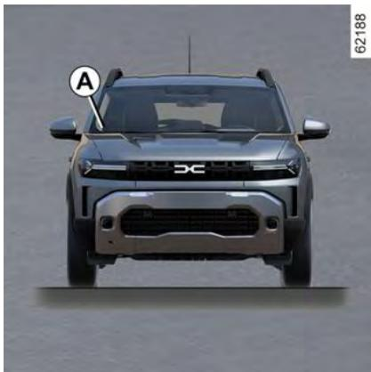
Über den QR code auf dem Aufkleber **A** erhält Rettungspersonal mit einem Tablet oder Smartphone sofort Zugriff auf die technische Information, die für Arbeiten am Fahrzeug im Notfall erforderlich sind.
