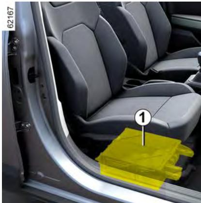
Je nach Fahrzeug befindet sich unter dem Beifahrersitz oder unter dem Fahrersitz in einem speziellen Fach eine Sekundärbatterie **1**: Sie liefert die für den Betrieb einiger Geräte erforderliche Energie.
