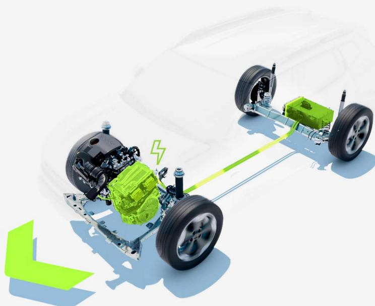
**La batería se recarga durante la conducción en las fases de frenado y desaceleración**
