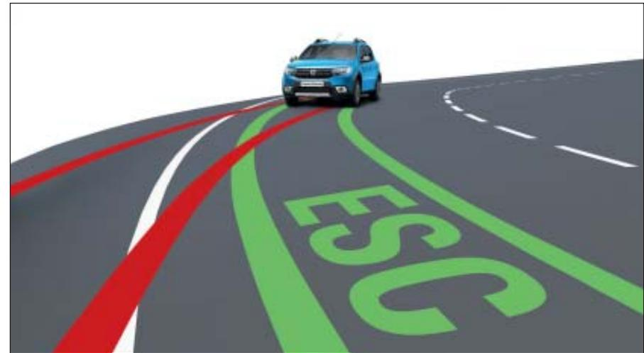
**ESP:** Permite controlar la estabilidad del vehículo en caso de pérdida de adherencia en las curvas, actuando sobre el reparto de la frenada y el régimen del motor.
