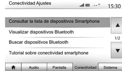
Puede gestionar los dispositivos conectados a su sistema multimedia en cualquier momento a través de «Ajustes» > «Conectividad Ajustes».
