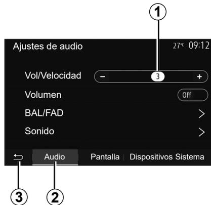
En el menú principal, pulse «Ajustes» para visualizar el menú de ajustes. Pulse **2** para acceder a los parámetros del sonido.
