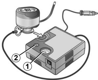
Según el vehículo, en caso de pinchazo, utilice el kit situado en el maletero o debajo de la moqueta del maletero.
