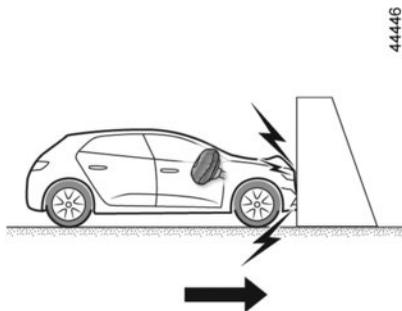
**En los casos siguientes se produce la activación de los pretensores o de los airbags.**
