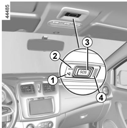
**1** Testigo de funcionamiento del sistema:
