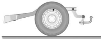
Los dispositivos de remolcado no deben ocultar ningún elemento de iluminación ni la placa de matrícula cuando no se utilicen. Los dispositivos de remolcado (bola, enganche, etc.) que pueden desmontarse sin herramientas o son retráctiles se deben retirar o cambiar de posición cuando no se utilicen. En cualquiera de los casos, debe respetar la legislación local del país donde esté circulado.
