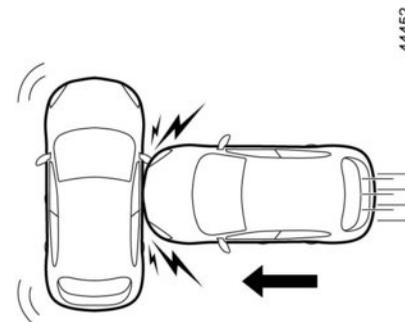
**En un choque lateral** con otro vehículo de una categoría equivalente o superior, a una velocidad de choque igual o superior a **50 km/h**.
