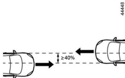
**En un choque frontal** con otro vehículo de una categoría equivalente o superior, con una zona de choque igual o superior al 40%, donde la velocidad de ambos vehículos es igual o superior a **40 km/h**.
