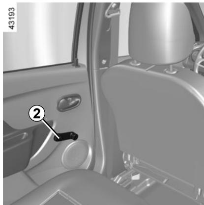
Evite colocar un objeto apoyado en un cristal entreabierto: se pueden dañar los elevalunas.
