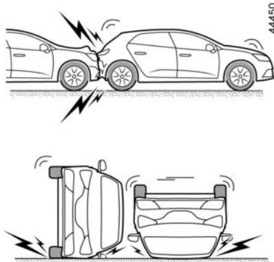
**En los ejemplos siguientes, puede que los pretensores y los airbags no se activen:**
