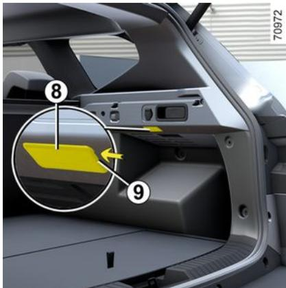
Suelte el iluminador **8** con un destornillador plano o herramienta similar para presionar la lengüeta **9** y bascular el iluminador hacia el interior del maletero.
