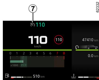
Pulse el interruptor **3** hasta que se encienda la luz **7** en color gris en el panel de instrumentos.
