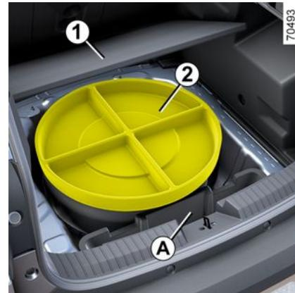
**Nota:** En ausencia de una rueda de repuesto o el kit de inflado de los neumáticos, no cargue el fondo del maletero. Según el vehículo, el kit de herramientas se encuentra en la bandeja **A** situada debajo de la moqueta del maletero.
