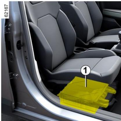
Según el vehículo, hay una batería secundaria **1** ubicada debajo del asiento del pasajero delantero o debajo del asiento del conductor en un compartimento específico: suministra la energía necesaria para hacer funcionar algunos equipos.
