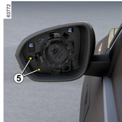
– aflojar los tornillos **5** con un destornillador;
