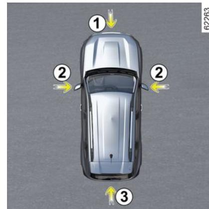
En caso de que estén instaladas en el vehículo, las cuatro cámaras **1**, **2** y **3** ubicadas en el paragolpes delantero, en los retrovisores exteriores y en el portón trasero le facilitan las maniobras difíciles.
