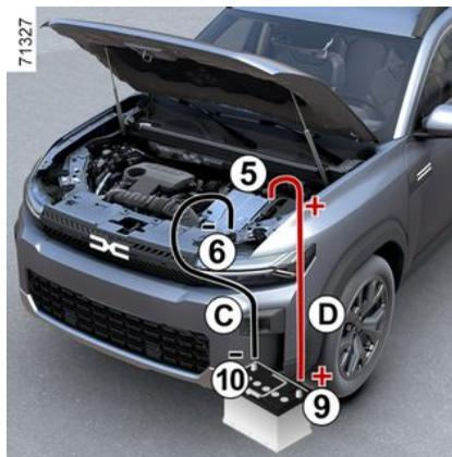
Conectar el cable positivo **D** al borne **5 (+)** y, a continuación, al borne **9 (+)** de la batería que suministra la corriente.
