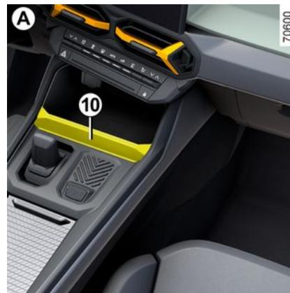
Coloque su smartphone (o tablet) en el soporte **10**. Asegúrese de que esté bien sujeto antes de utilizarlo.
