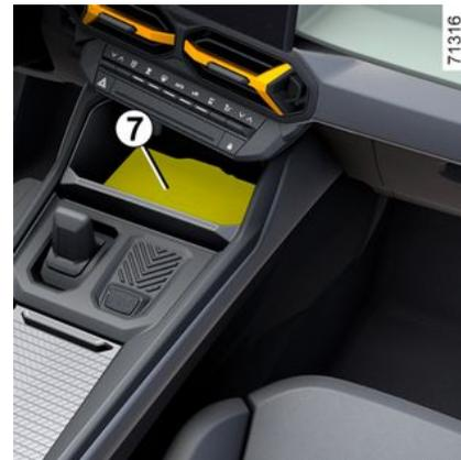
En función del vehículo, el símbolo **8** indica que puede utilizar la zona **7** para cargar su teléfono sin necesidad de tener que recurrir a un cable de carga.
