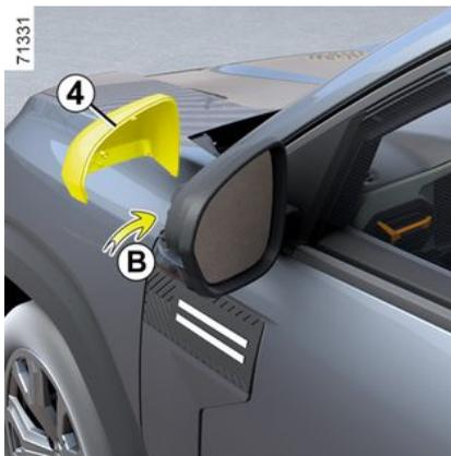
– soltar la carcasa **4** con un destornillador de punta plana o similar (movimiento **B**);
