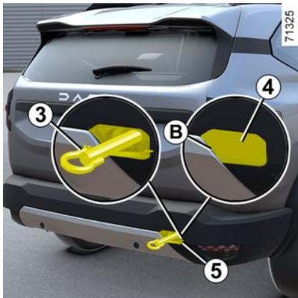
Para tener acceso al punto de remolcado **5**, suelte la tapa trasera **4** insertando un destornillador de punta plana o similar por la muesca **B** situada debajo de esta.
