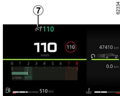
Pulse el interruptor **3** hasta que se encienda la luz **7** en color gris en el panel de instrumentos. El mensaje "Limitador activado" se enciende en el cua-
