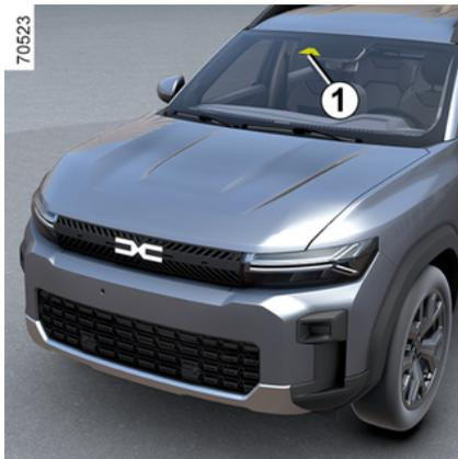
El sistema utiliza información procedente de la cámara **1**, para determinar la distancia que separa a su vehículo:
