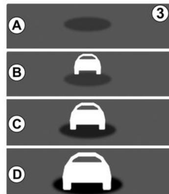
Con la función activada, se muestra el indicador **3** en el cuadro de instrumentos para informar al conductor de la distancia entre su vehículo y el de delante:
