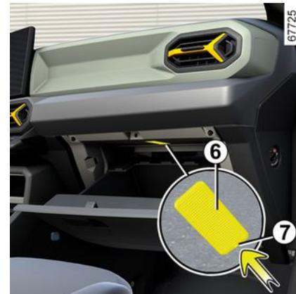
Soltar la luz 6 con un destornillador plano o un útil similar, presionando la pestaña 7 para mover la luz hacia el interior de la guantera.
