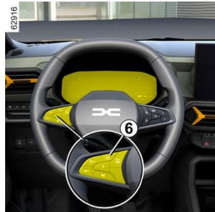
Para adaptar la consigna del limitador de velocidad, del regulador de velocidad o del regulador de velocidad adaptativo Stop and Go al límite de velocidad que se detecte en cada momento, pulse el interruptor **6**.
