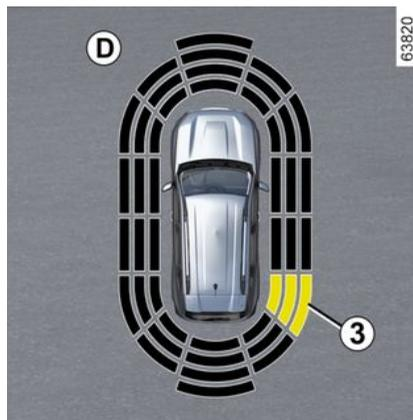
Según la orientación de las ruedas, el sistema determina la trayectoria del vehículo y notifica al conductor si hay riesgo de colisión o de no colisión con un obstáculo **3** situado en el lateral del vehículo.
