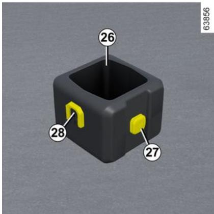
Para instalar la base en vehículos equipados, deslice la base **28** del cubo de arriba hacia abajo en el soporte multiaccesorio **22** o **23**.
