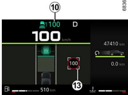
En caso de que el vehículo esté equipado con la función "Reconocimiento de señales de tráfico" → 235, presione el botón 4 para adaptar la velocidad a los límites de velocidad 13 que detecta la cámara.
