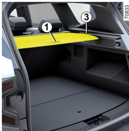
Desde la posición intermedia, levante la cubierta, tire ligeramente de la palanca **1** y coloque cada extremo de la cubierta en la muesca **4**.
