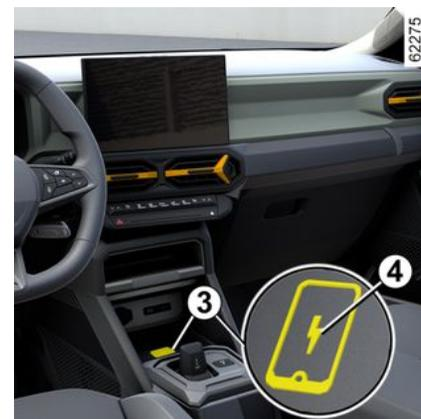
En función del vehículo, el símbolo 4 indica que el área 3 se puede usar para cargar su teléfono sin usar un cable de carga.
