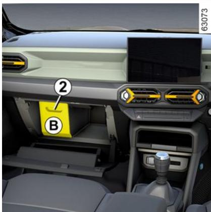
Si un componente eléctrico no funciona, verifique el estado de los fusibles. Soltar la tapa **A** empleando la muesca **1** o, según el vehículo, soltar la tapa **B** empleando la muesca **2**.
