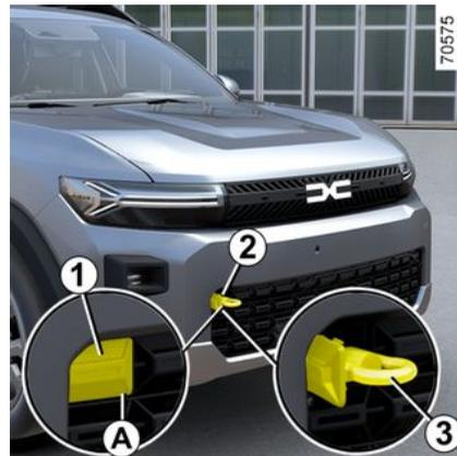
Para tener acceso al punto de remolcado **2**, suelte la tapa delantera **1** insertando un destornillador de punta plana o similar por la muesca **A** situada debajo de esta.
