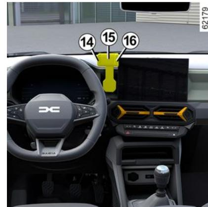
– coloque el teléfono en el soporte **15** presionando la abrazadera fija **14**; a continuación, suelte la abrazadera **16** para que el teléfono quede firmemente sujeto entre las abrazaderas **14** y **16**.
