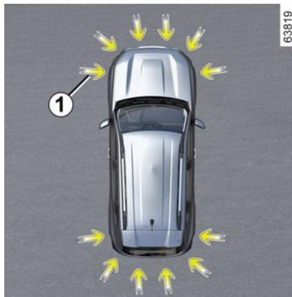
Los sensores ultrasónicos, indicados por las flechas **1**, están instalados en los paragolpes con el fin de detectar
