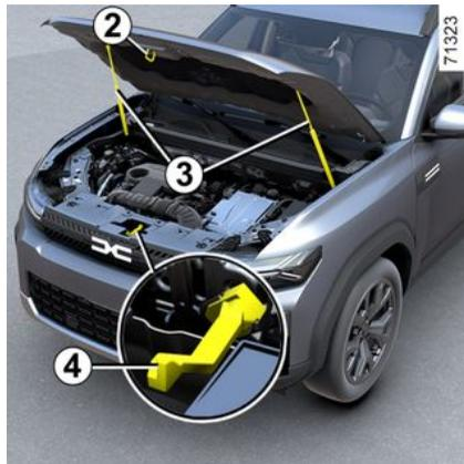
Para desbloquearlo, levante ligeramente el capó y suelte el gancho **2** empujando el tirador **4** hacia la izquierda.
