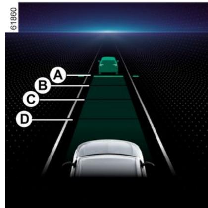
Puede cambiar la distancia de seguridad con el vehículo de delante en cualquier momento pulsando el botón 7 repetidamente.
