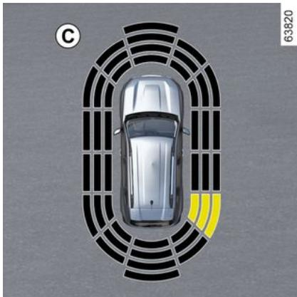
El sistema es capaz de detectar la mayoría de los obstáculos ubicados cerca de la parte trasera y, en función del equipamiento, cerca de la parte delantera y los laterales del vehículo.
