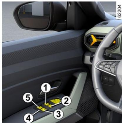
Pulse brevemente el mando de un cristal o tire de él hasta el máximo posible: el cristal subirá o bajará totalmente. Una acción sobre el mando de tiene el desplazamiento del cristal.
