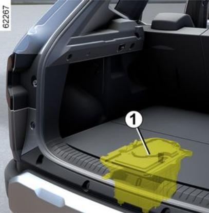
La batería de "12 V" **1** se encuentra ubicada en la parte trasera del vehículo Hybrid; suministra la energía necesaria para desbloquear/bloquear el vehículo y hacer funcionar el equipamiento.
