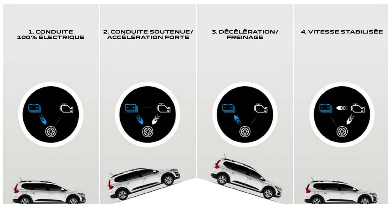
1. Conduite 100 % électrique : seul le moteur électrique entraine les roues.
