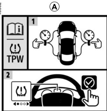
Lorsque le véhicule en est équipé, ce système détecte une perte de pression dans un des pneumatiques en mesurant la vitesse des roues pendant la conduite.
