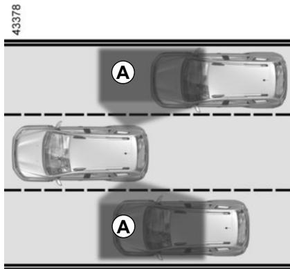
Ce système informe le conducteur lorsqu'un autre véhicule se trouve dans le périmètre de détection **A**.
