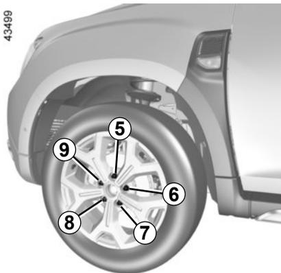
Serrez les vis en vous assurant du bon placage de la roue sur son moyeu et descendez le cric.
