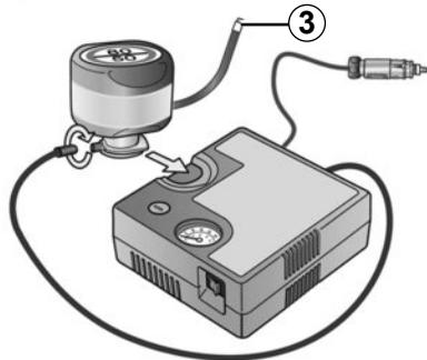
Une fois que le pneumatique correctement gonflé, déposez le kit : dévissez lentement l'embout de gonflage de la bouteille **3** de manière à éviter la projection de produit et stockez la bouteille dans un emballage en plastique pour éviter l'écoulement du produit.
