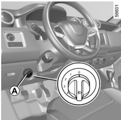
Suivant véhicule, la commande **A** permet de corriger la hauteur des faisceaux en fonction de la charge.
