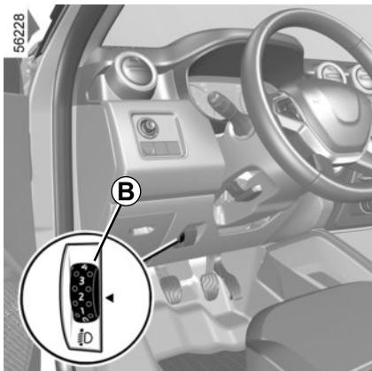
Pour les véhicules qui en sont équipés, la commande **B** permet de corriger la hauteur des faisceaux en fonction de la charge.
