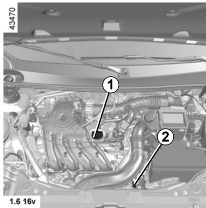
Ne dépassez pas le niveau « **maxi** » et n'oubliez pas de remettre la jauge **2** et le bouchon **1**.
