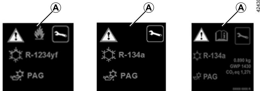
Le circuit de fluide frigorigène (dont certains éléments sont hermétiquement scellés) contient des gaz à effet de serre fluorés.
