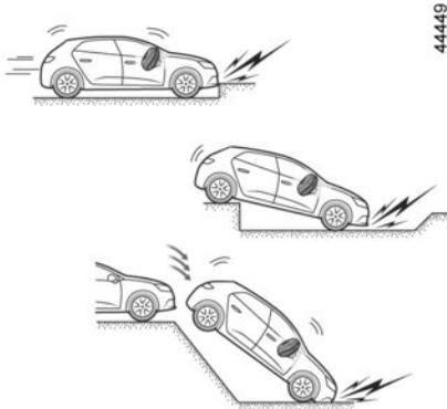
**Dans les exemples de cas suivants, les prétensionneurs ou les airbags sont susceptibles d'être déclenchés :**
