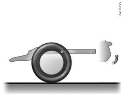
Un dispositif d'attelage ne doit pas masquer un élément d'éclairage ou plaque d'immatriculation lorsqu'il n'est pas utilisé. Les dispositifs d'attelage mécanique (rotule, crochet...) démontables sans outils ou escamotables doivent être enlevés ou repositionnés lorsqu'ils ne sont pas utilisés.
