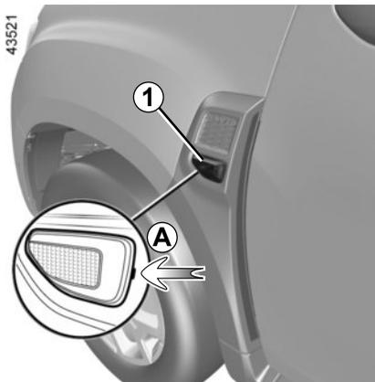
Déclipsez le répéteur **1** à l'aide d'un outil type tournevis plat positionné en **A** et basculez le répéteur vers l'extérieur du véhicule.
