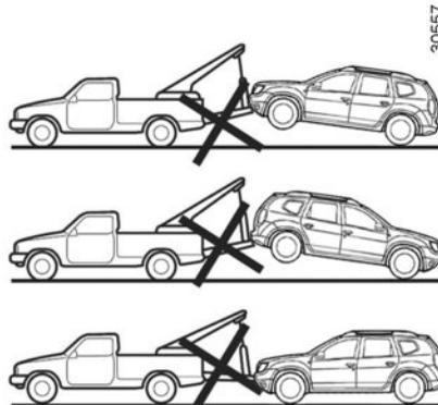
Vous ne devez jamais remorquer le véhicule 4 roues motrices, quelque soit le mode sélectionné, si l'une de ses 4 roues touche le sol (sauf pour le dépannage hors route).
