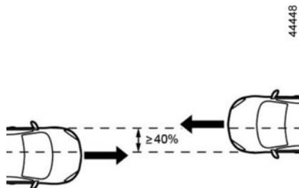
**En choc frontal** avec un autre véhicule de catégorie équivalente ou supérieure, sur un recouvrement égal ou supérieur à 40%, les vitesses des deux véhicules étant égales ou supérieures à **40 km/h**.
