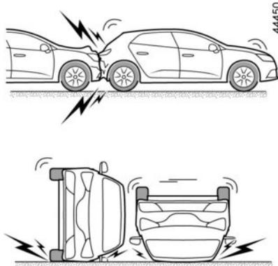
**Dans les exemples de cas suivants, les prétensionneurs ou les airbags sont susceptibles de ne pas être déclenchés :**
