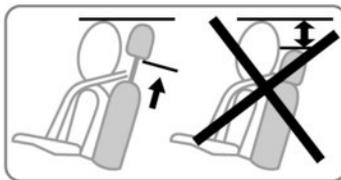
**La position de l'appui-tête complètement abaissée (position B) est une position de rangement : elle ne doit pas être utilisée lorsqu'un passager est assis.**
