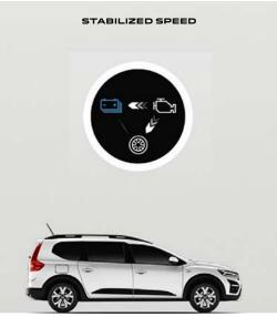
THE INTERNAL COMBUSTION ENGINE RUNS AT ITS OPTIMUM SPEED TO DRIVE THE WHEELS AND RECHARGE THE BATTERY
