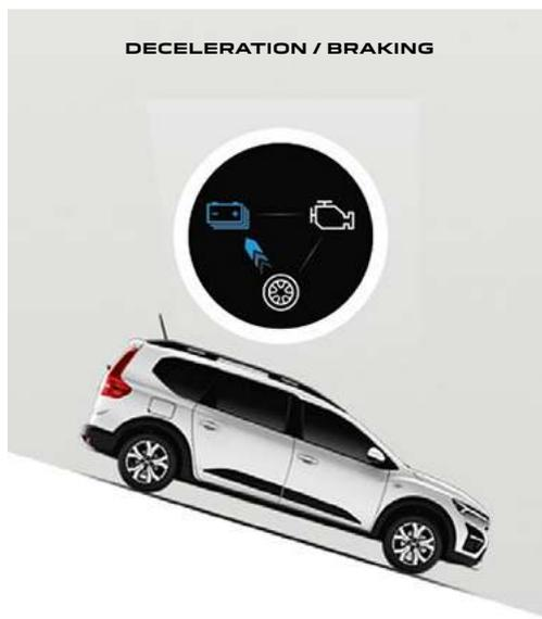
**THE ELECTRIC MOTORS RECHARGE THE BATTERY**
