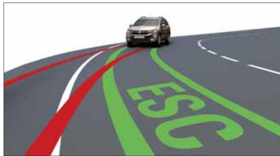
**Sustav ESC**: stabilizira putanje vozila u slučaju gubitka prianjanja guma u zavoju raspoređivanjem kočione sile i prilagođavanjem okretaja motora.
