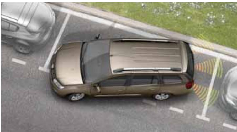
**Stražnji parkirni senzori\***: zvučnim signalima upozorava vozača na prepreku iza vozila. Za još više udobnosti i sigurnosti sustav možete povezati s kamerom za vožnju unatrag.
