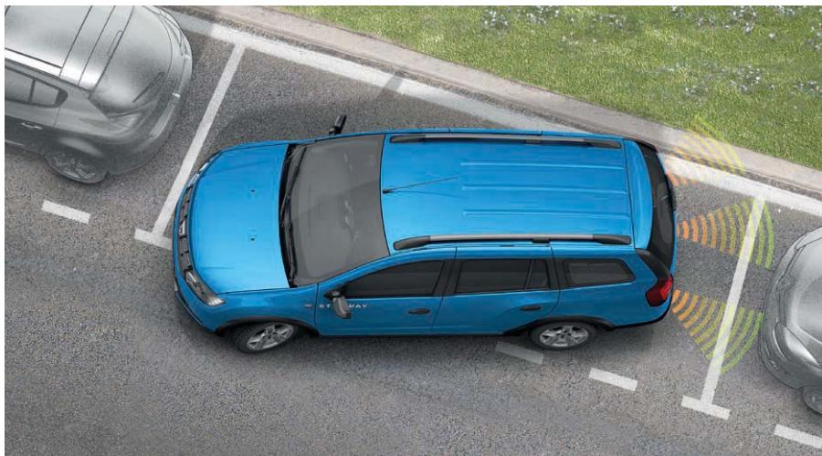
**Sensori di parcheggio posteriori\***: i segnali sonori ti avvisano di eventuali ostacoli presenti dietro al veicolo mediante una serie di bip sempre più ravvicinati. Per aumentare ulteriormente il comfort e la sicurezza, il sistema può essere abbinato alla retrocamera posteriore.
