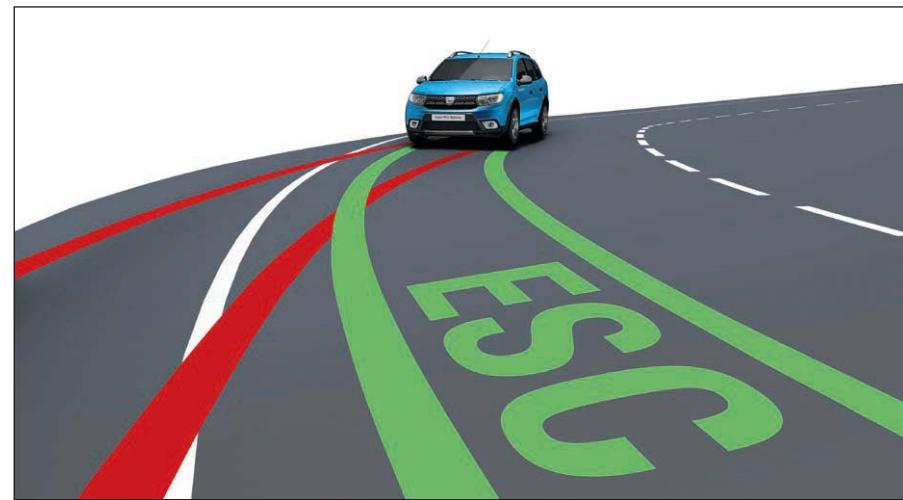
**ESC**: il sistema di controllo elettronico della stabilità garantisce l'aderenza del veicolo in caso di perdita di aderenza in curva, agendo sulla ripartizione della frenata e sui giri del motore.
