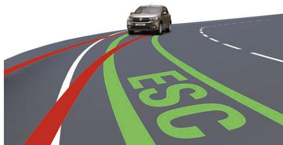
**ESC:** il sistema di controllo elettronico della stabilità garantisce l'aderenza del veicolo in caso di perdita di aderenza in curva, agendo sulla ripartizione della frenata e sui giri del motore.
