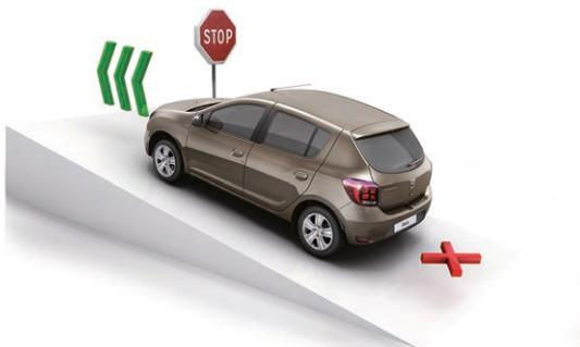
**Assistenza alla partenza in salita:** In caso di partenza in salita, il sistema mantiene automaticamente la corretta pressione sul freno per 2 secondi per lasciare al conducente il tempo di impostare la manovra.
