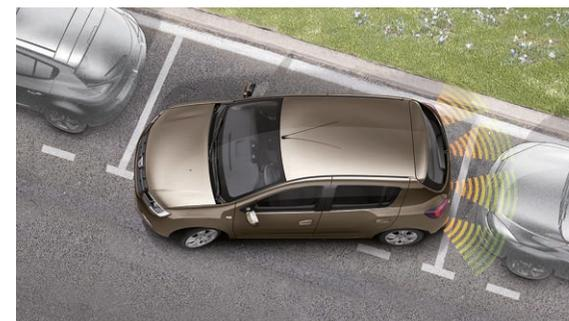
**Sensori di parcheggio posteriori:** i segnali sonori ti avvisano di eventuali ostacoli presenti dietro al veicolo mediante una serie di bip sempre più ravvicinati. Per aumentare ulteriormente il comfort e la sicurezza, il sistema può essere abbinato alla retrocamera posteriore.
