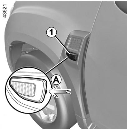
Déclippez le répéteur **1** à l'aide d'un outil type tournevis plat positionné en **A** et basculez le répéteur vers l'extérieur du véhicule.
