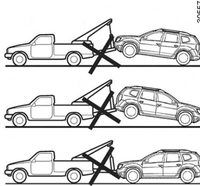
Vous ne devez jamais remorquer le véhicule 4 roues motrices, quelque soit le mode sélectionné, si l'une de ses 4 roues touche le sol (sauf pour le dépannage hors route).
