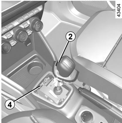
Pour cela, déclipsez la base du levier, puis passez un outil (tige rigide) dans la fente **4** et appuyez simultanément sur le bouton **2** afin de déverrouiller le levier.
