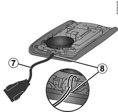
Insérez la dragonne dans l'élément 8 et passez l'extrémité de la dragonne dans la boucle.
