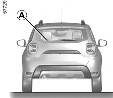
Le QR code figurant sur l'étiquette **A** permet aux professionnels de secours au moyen d'une tablette ou d'un smartphone, d'accéder immédiatement aux informations techniques utiles pour une intervention sur le véhicule en cas d'accident.
