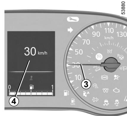
**Indicateur de vitesse 3 et, suivant véhicule, 4**
