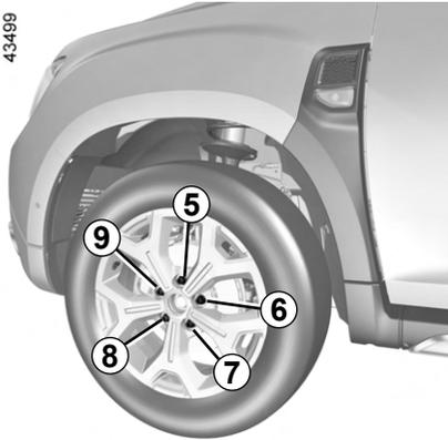
Serrez les vis en vous assurant du bon placage de la roue sur son moyeu et descendez le cric.
