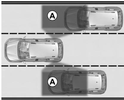
Ce système informe le conducteur lorsqu'un autre véhicule se trouve dans le périmètre de détection **A**.
