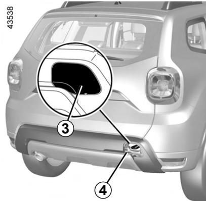
Ces points de remorquage ne peuvent être utilisés qu'en traction, en aucun cas ils ne doivent servir pour soulever directement ou indirectement le véhicule.
