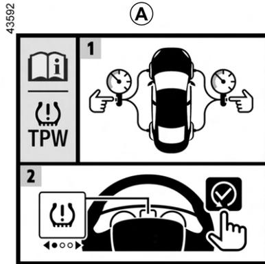
Lorsque le véhicule en est équipé, ce système détecte une perte de pression dans un des pneumatiques en mesurant la vitesse des roues pendant la conduite.
