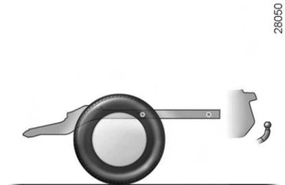
Un dispositif d'attelage ne doit pas masquer un élément d'éclairage ou plaque d'immatriculation lorsqu'il n'est pas utilisé. Les dispositifs d'attelage mécanique (rotule, crochet...) démontables sans outils ou escamotables doivent être enlevés ou repositionnés lorsqu'ils ne sont pas utilisés.
